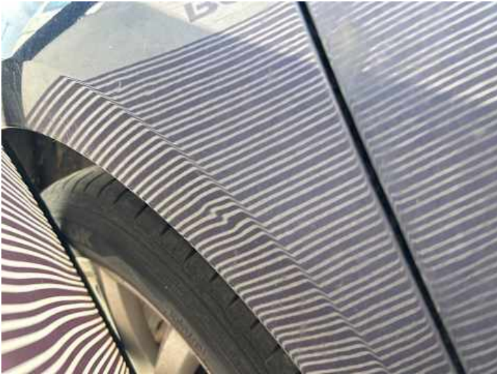
Seitenteil hinten rechts (Verformung)
