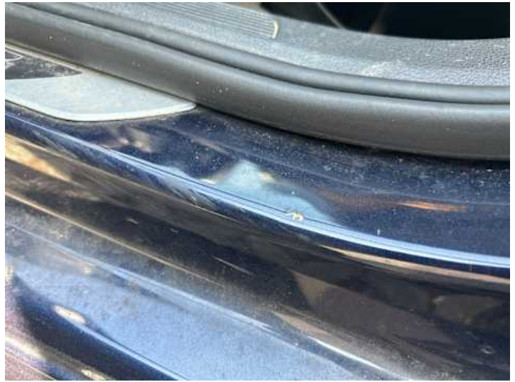
Schweller links (Lackschaden)
