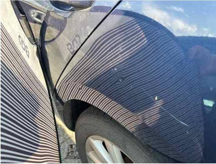
Seitenteil hinten links (Delle, Kratzer, Lackschaden)
