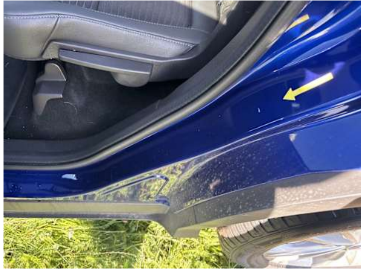
Türe hinten links (Kratzer)
