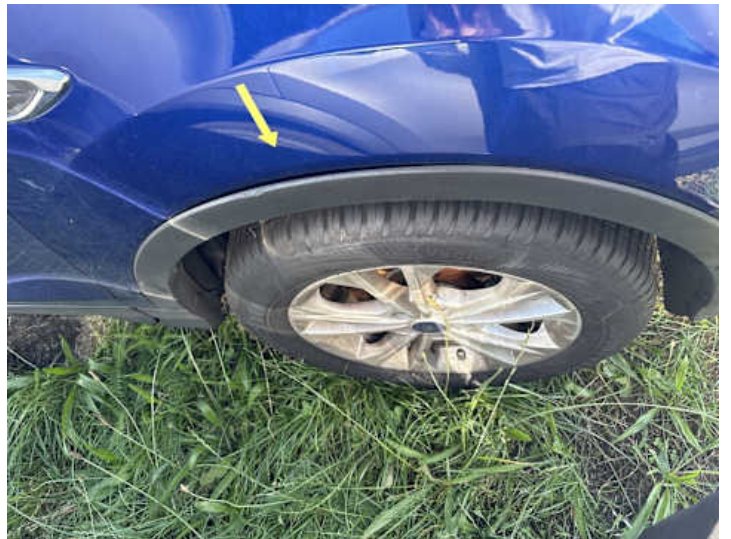
Kotflügel vorne rechts (Spaltmaße ungenau)
