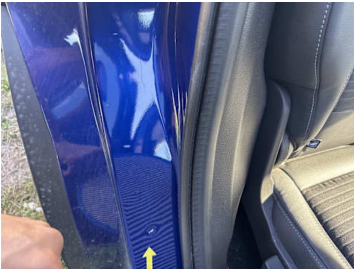
Türe hinten rechts (Delle, Kratzer)
