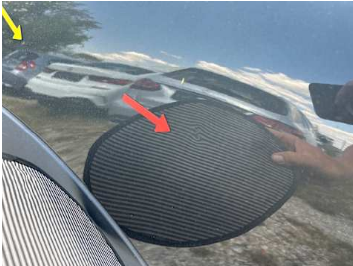
Seitenteil hinten rechts (Delle, Verformung)
