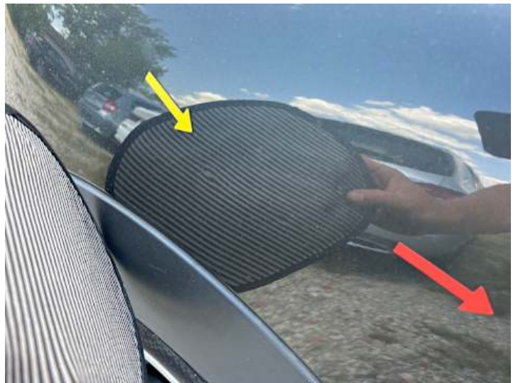
Seitenteil hinten rechts (Delle, Verformung)
