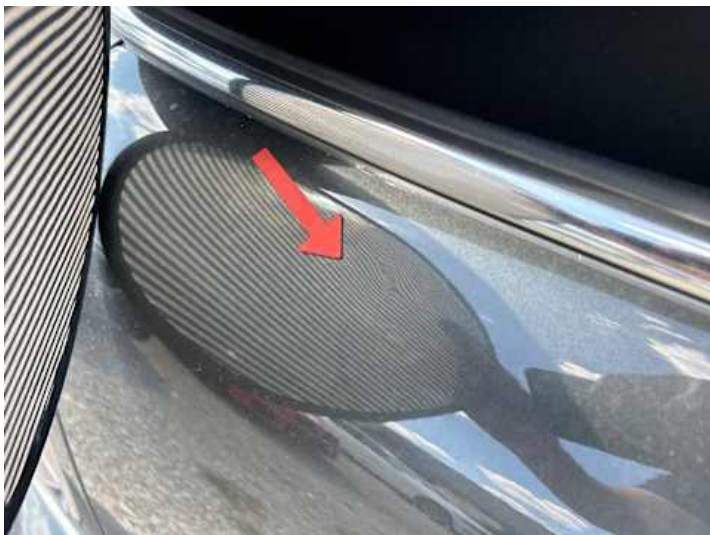
Heckklappe (Delle, Kratzer)
