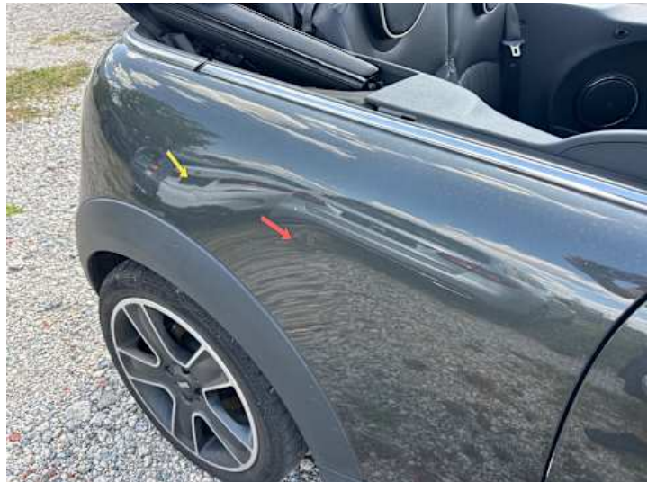
Seitenteil hinten rechts (Delle, Verformung)
