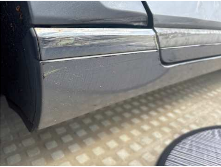
Schweller rechts (Kratzer, Verformung, Lackschaden)
