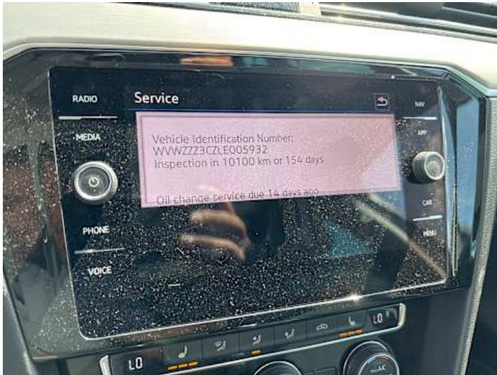
Innenraum (Anderer Schaden): Servicebildschirm wird nicht vollständig angezeigt,
