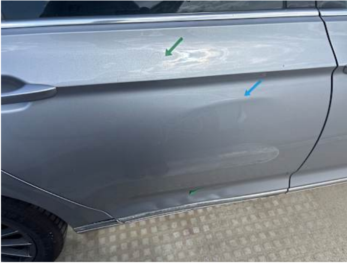
Türe hinten rechts (Delle, Kratzer, Lackschaden)
