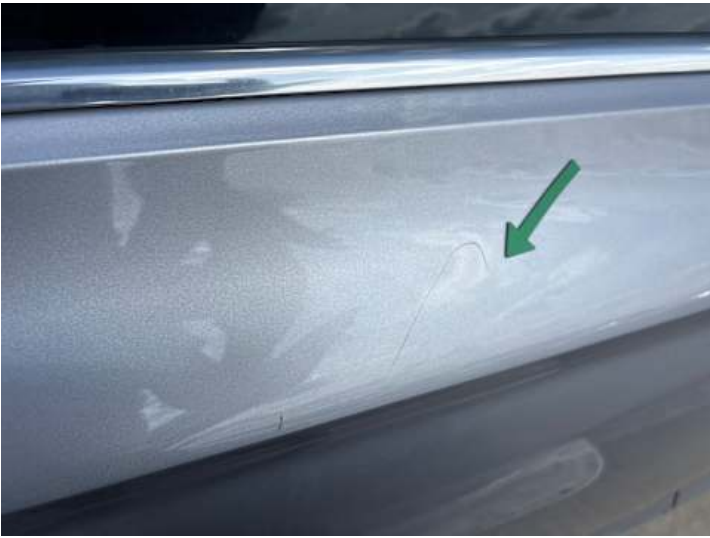
Türe hinten rechts (Delle, Kratzer, Lackschaden)
