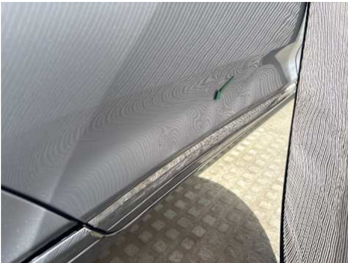
Türe hinten rechts (Delle, Kratzer, Lackschaden)
