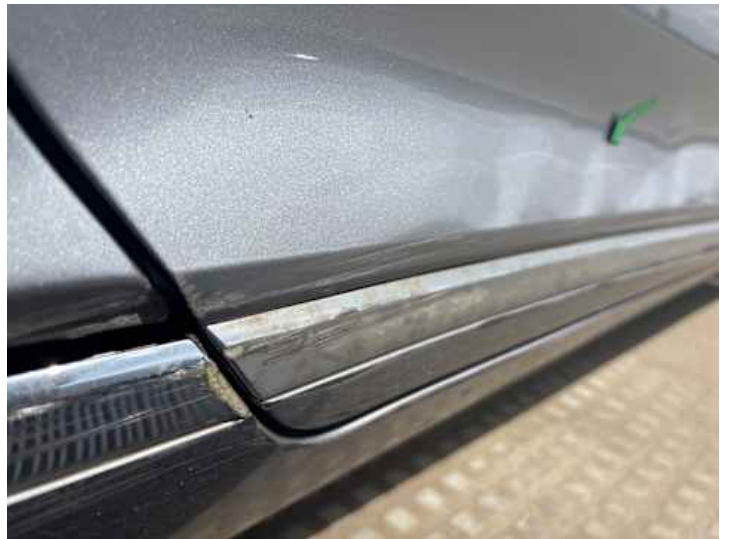
Türe hinten rechts (Delle, Kratzer, Lackschaden)
