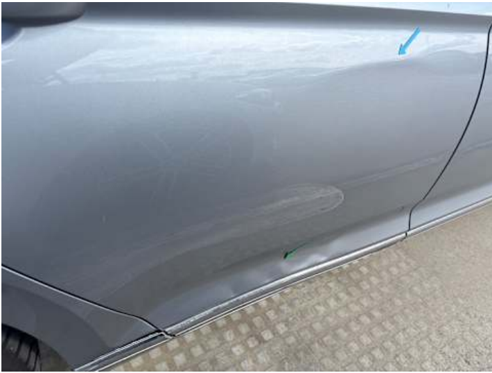
Türe hinten rechts (Delle, Kratzer, Lackschaden)
