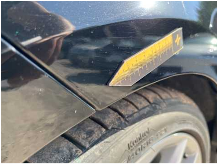
Kotflügel vorne links (Rost)
