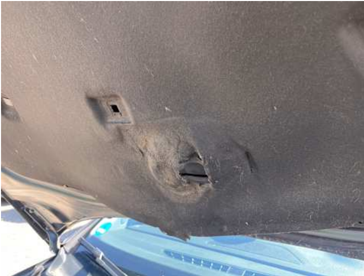
Motorhaube (Anderer Schaden, Riss/Bruch): Motorraum Auffälligkeiten / Beschädigungen
