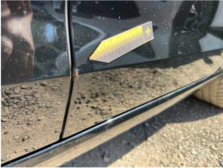
Türe hinten links (Rost)
