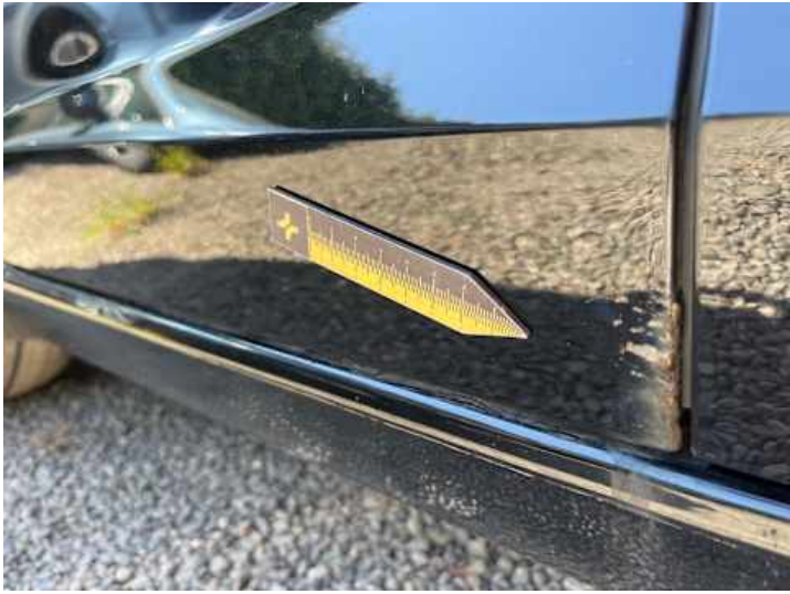
Türe hinten rechts (Rost)
