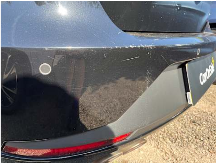
Stoßstange hinten (Kratzer, Verformung)
