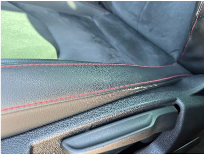
Innenraum (Verschleiß, Riss/Bruch)
