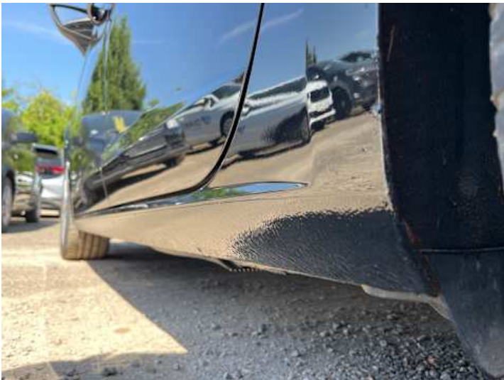
Schweller links (Rost)
