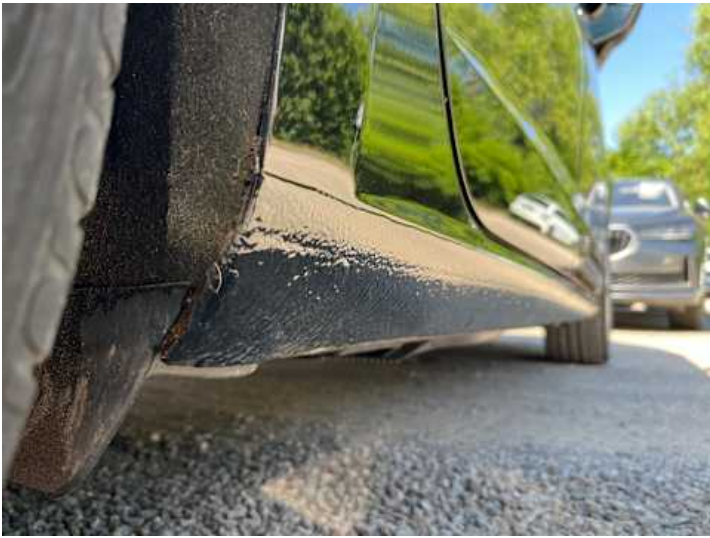
Schweller rechts (Rost)
