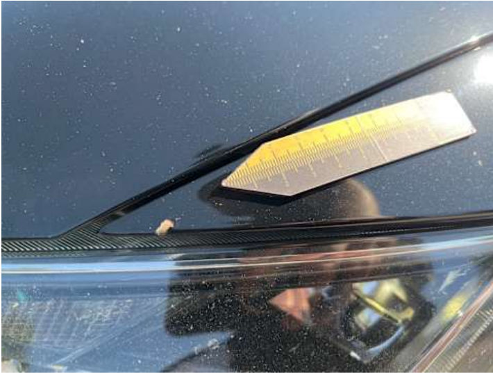
Kotflügel vorne links (Steinschlag, Rost)
