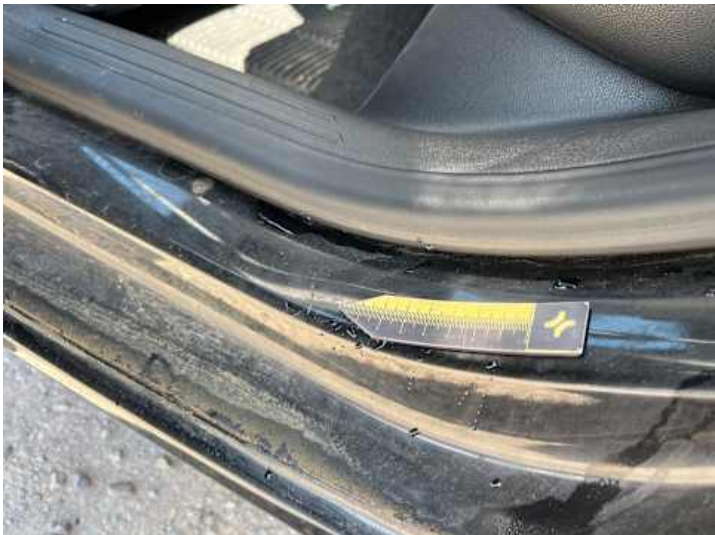
Schweller links (Kratzer)
