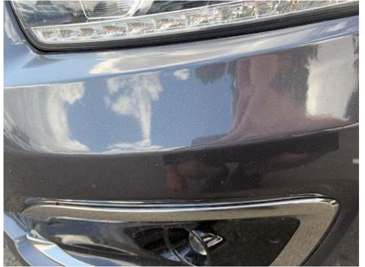
Stoßstange vorne (Steinschlag, Verformung)
