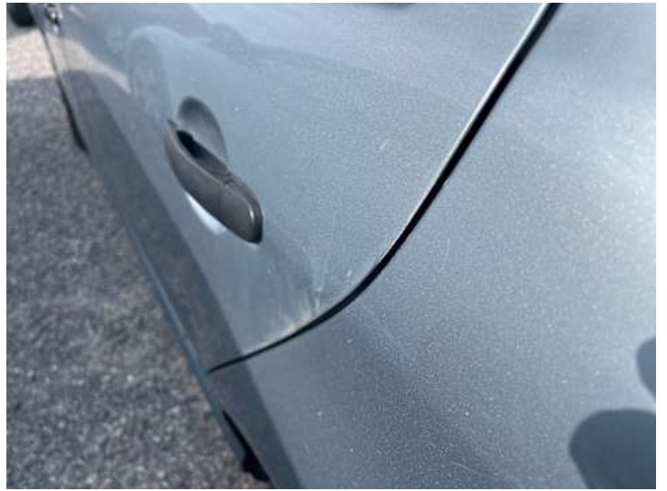
Türe hinten links (Lackschaden)
