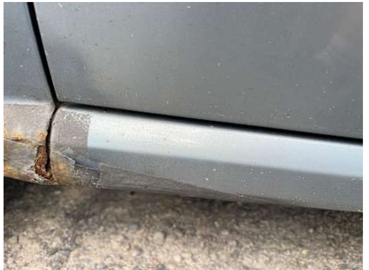
Schweller links (Rost)
