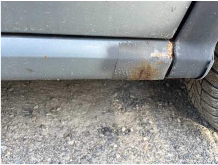
Schweller rechts (Rost)
