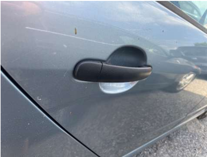
Türe hinten rechts (Kratzer, Lackschaden)
