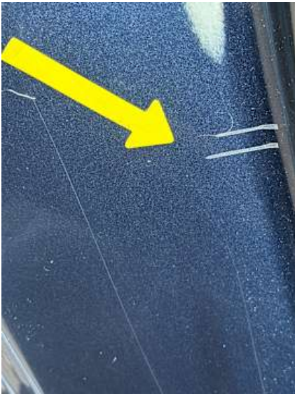
Schweller rechts (Kratzer)
