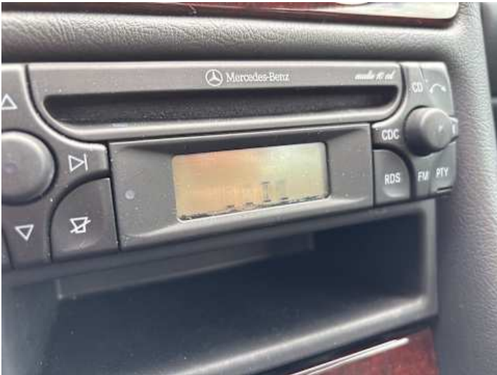
Innenraum (Anderer Schaden): Pixelfehler
