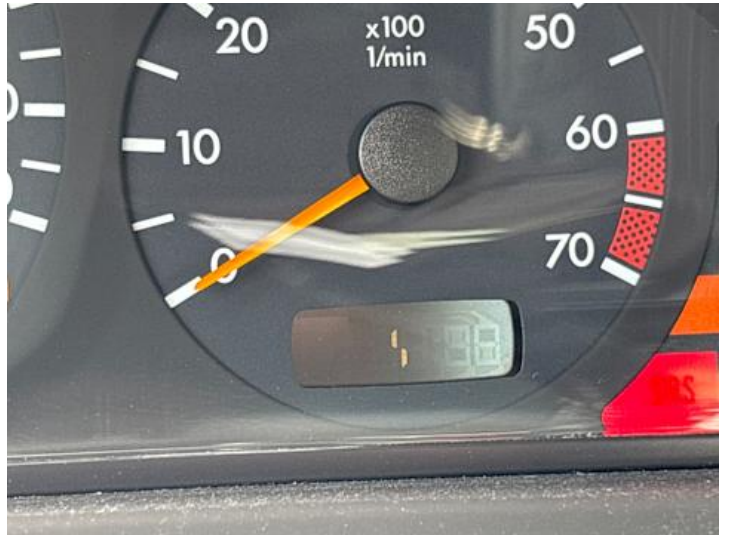
Innenraum (Anderer Schaden): Pixelfehler
