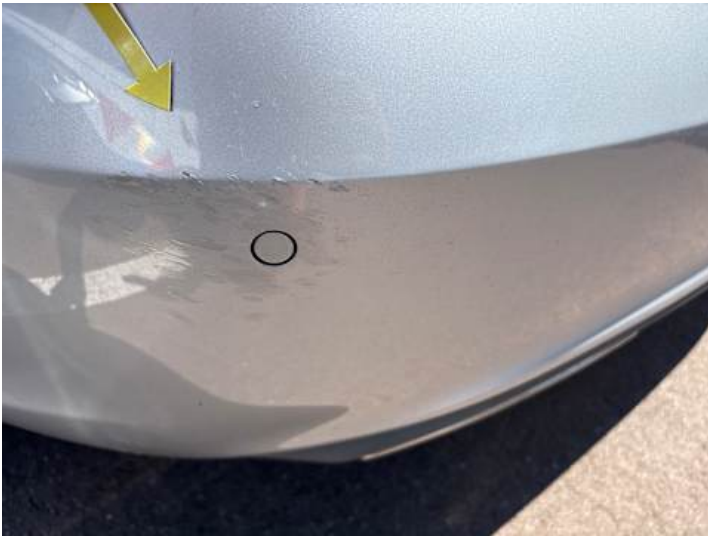
Stoßstange hinten (Lackschaden)
