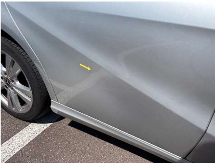
Türe hinten rechts (Verformung)
