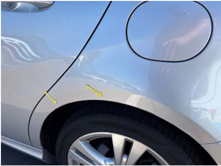
Seitenteil hinten links (Lackschaden, Rost)
