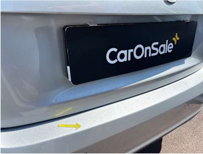
Stoßstange hinten (Lackschaden)
