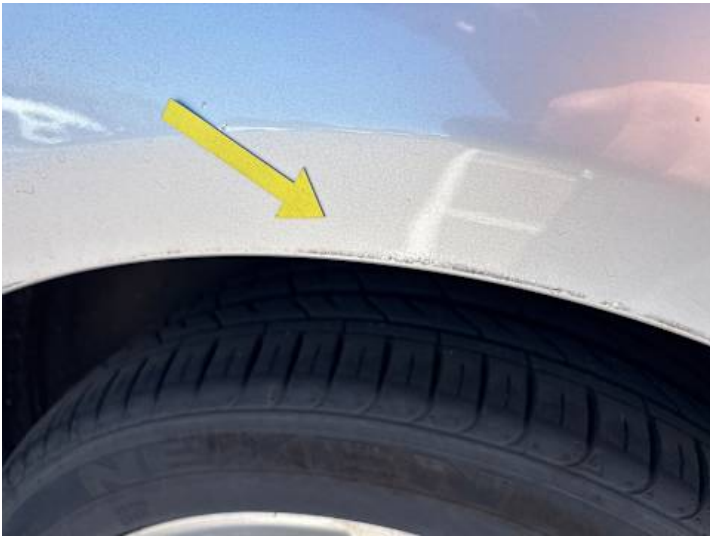
Seitenteil hinten links (Lackschaden, Rost)
