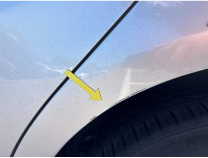
Seitenteil hinten links (Lackschaden, Rost)
