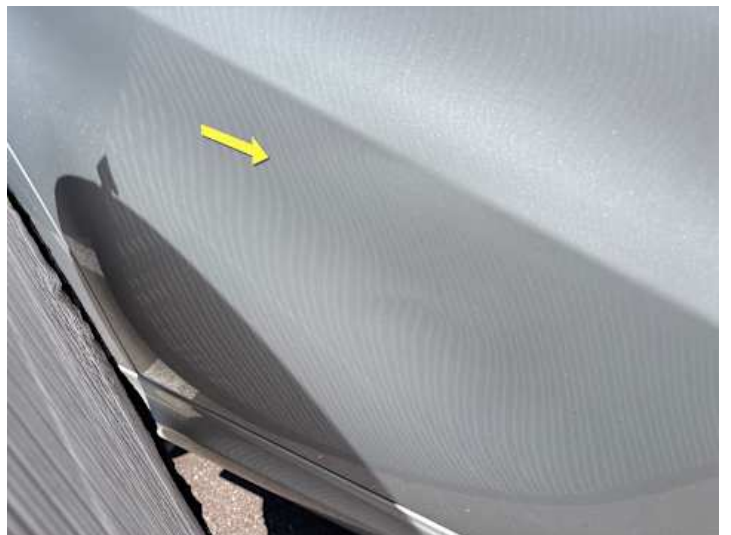
Türe hinten rechts (Verformung)
