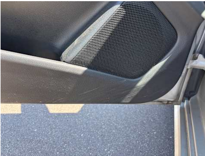
Innenraum (Verschleiß, Kratzer)
