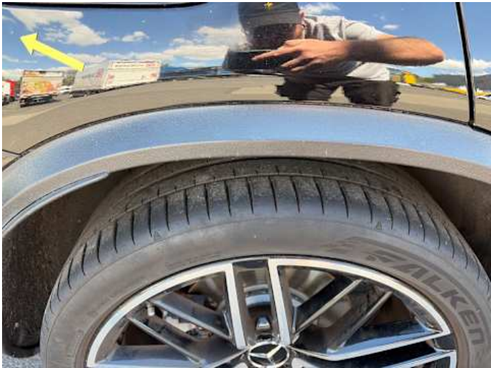
Seitenteil hinten rechts (Verformung, Kratzer)
