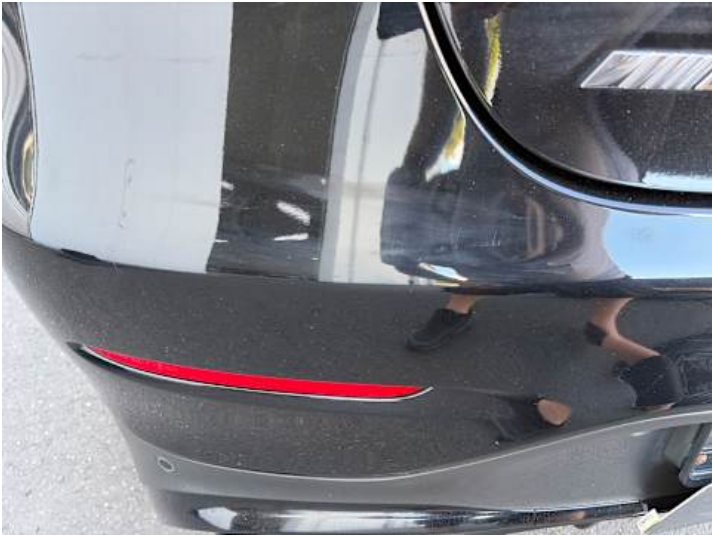
Stoßstange hinten (Kratzer)
