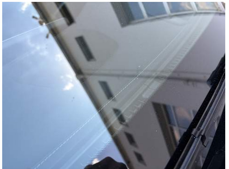
Windschutzscheibe (Steinschlag, Riss/Bruch)
