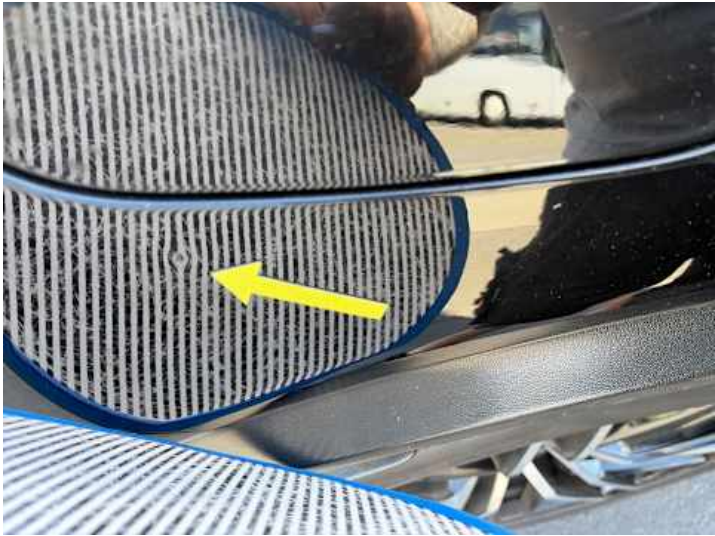
Seitenteil hinten rechts (Delle)
