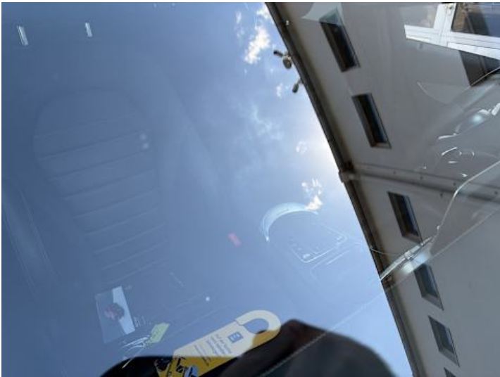
Windschutzscheibe (Steinschlag, Riss/Bruch)
