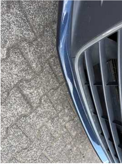
Stoßstange vorne (Delle)
