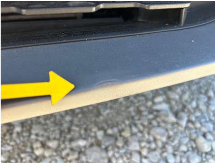
Stoßstange vorne (Kratzer, Verformung)
