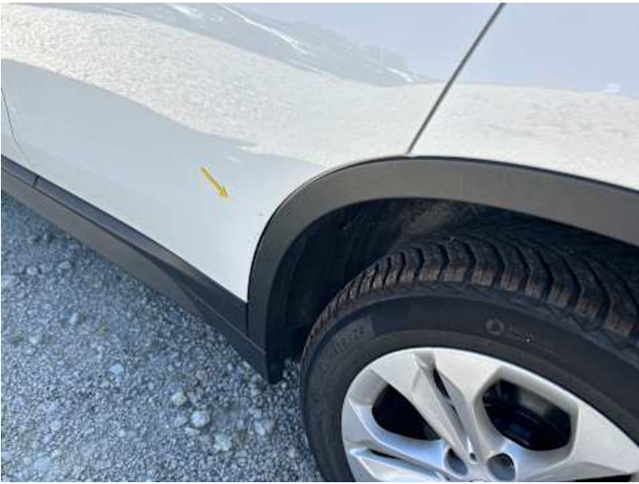
Türe hinten links (Kratzer)
