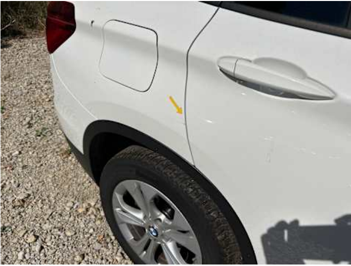
Seitenteil hinten rechts (Kratzer, Verformung)
