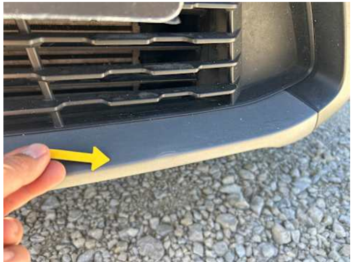
Stoßstange vorne (Kratzer, Verformung)
