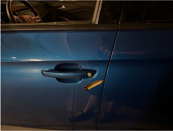
Fahrertür (Lackschaden, Unsachgemäß instand gesetzt)
