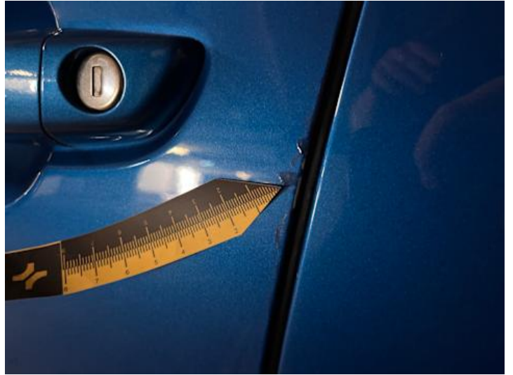
Fahrertür (Lackschaden, Unsachgemäß instand gesetzt)
