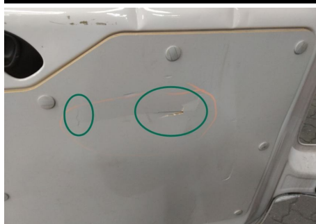
Innenverkleidung Laderaum / Unten Hinten Links / Gebrochen
