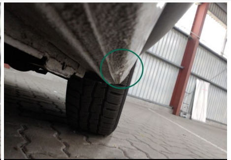
Schweller / Vorne Rechts / Delle
