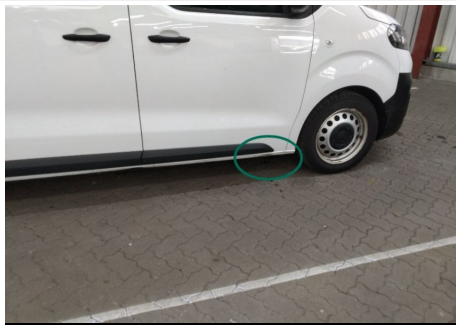
Schweller / Vorne Rechts / Delle
