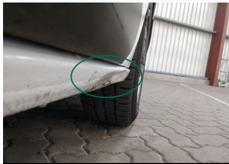
Schweller / Vorne Rechts / Delle
