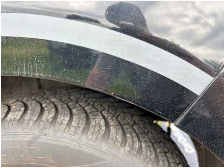
Seitenteil hinten links (Steinschlag)
