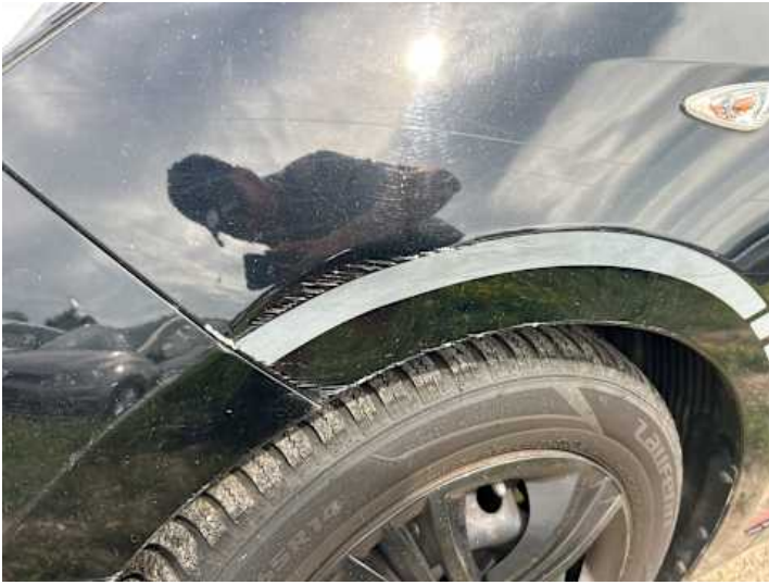
Kotflügel vorne rechts (Delle, Kratzer, Lackschaden)
