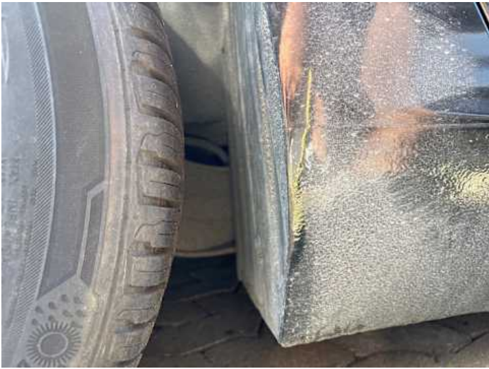
Seitenteil hinten rechts (Kratzer, Unsachgemäß instand gesetzt)
