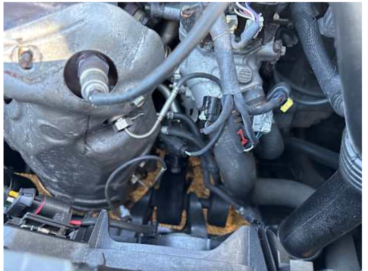
Motorhaube (Anderer Schaden): Kabel nicht befestigt
