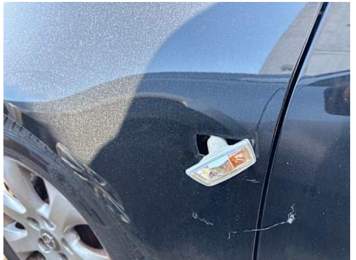
Kotflügel vorne links (Riss/Bruch)
