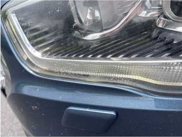
Scheinwerfer (links) (Anderer Schaden): Rissig/porös
