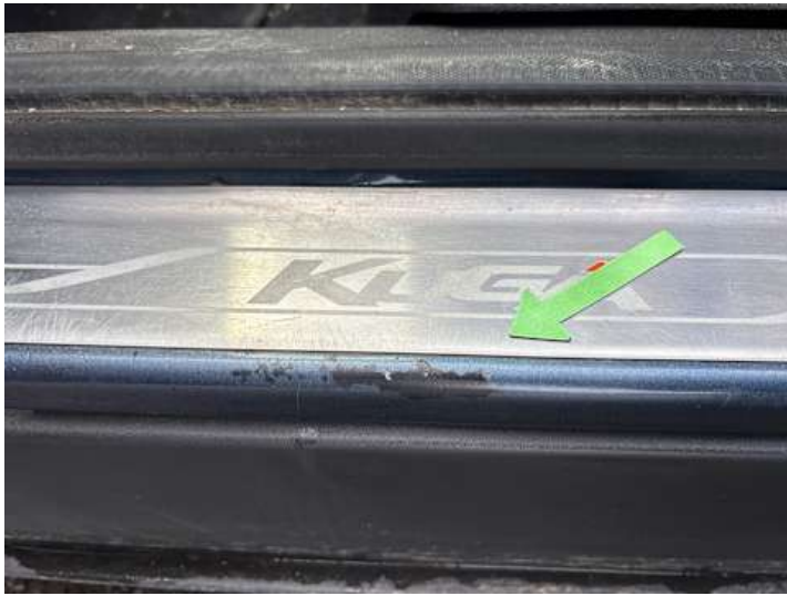
Schweller links (Lackschaden)
