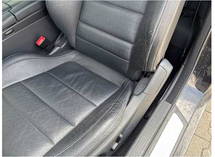
Innenraum (Verschmutzung, Verschleiß)
