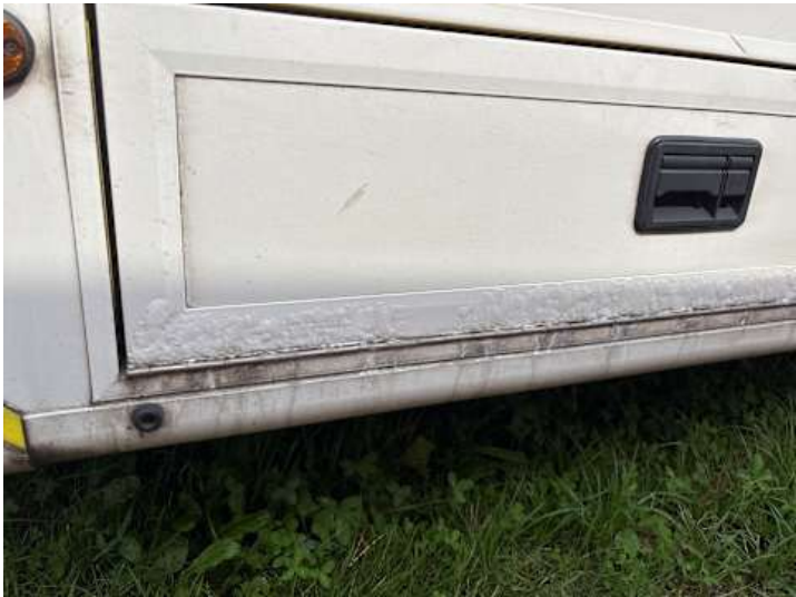
Seitenteil hinten links (Rost)
