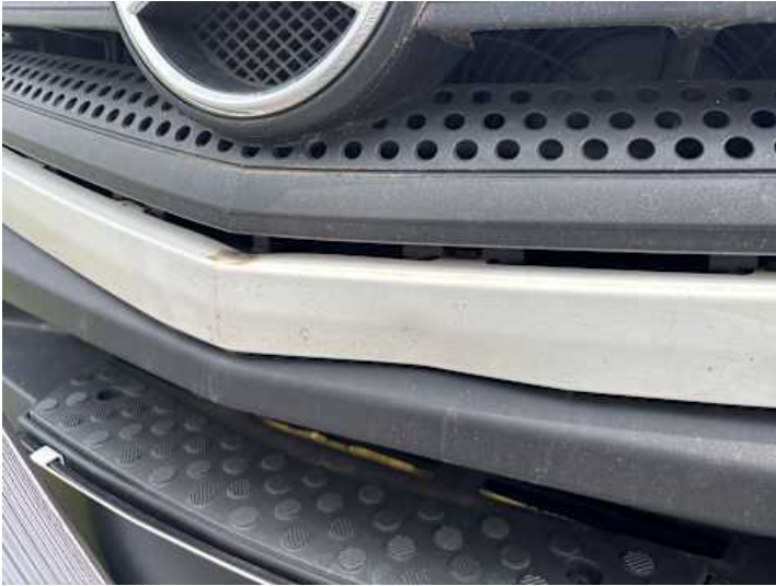
Stoßstange vorne (Kratzer, Verformung)
