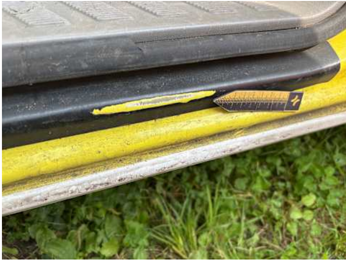
Schweller links (Kratzer)
