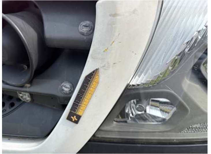
Stoßstange vorne (Kratzer, Verformung)
