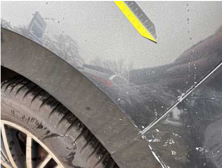
Seitenteil hinten links (Lackschaden)
