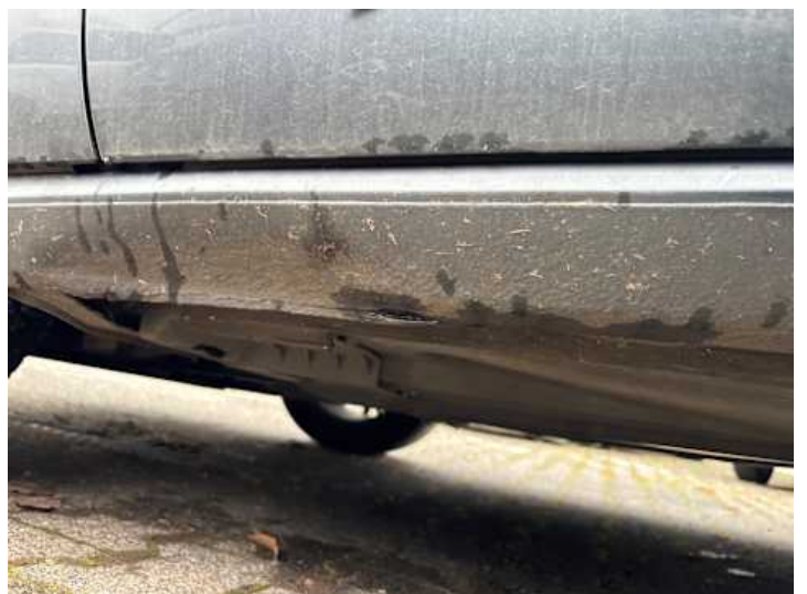
Schweller links (Verformung, Riss/Bruch)
