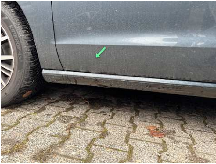
Schweller links (Verformung, Riss/Bruch)
