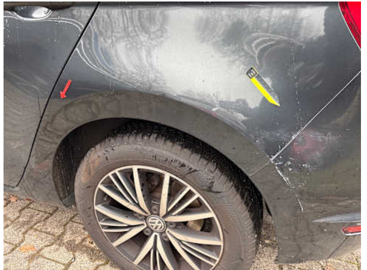
Seitenteil hinten links (Lackschaden)
