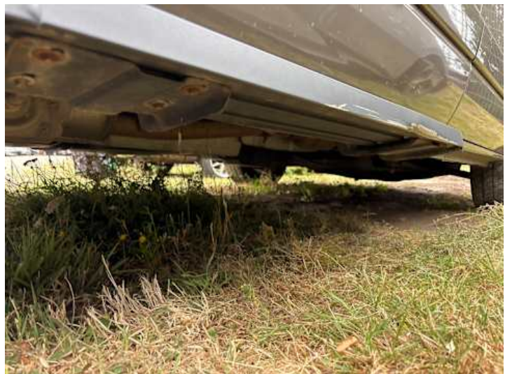
Schweller rechts (Kratzer, Lackschaden, Verformung)
