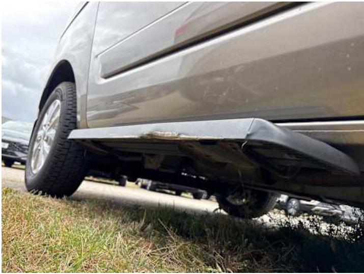
Schweller rechts (Kratzer, Lackschaden, Verformung)
