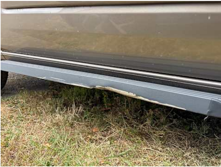
Schweller rechts (Kratzer, Lackschaden, Verformung)
