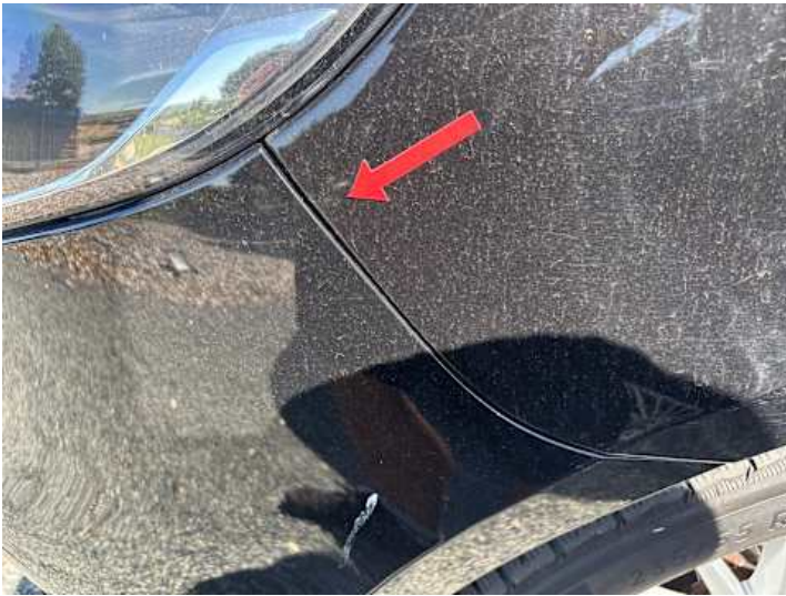
Stoßstange vorne (Spaltmaße ungenau)
