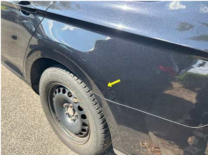
Seitenteil hinten links (Kratzer, Verformung)
