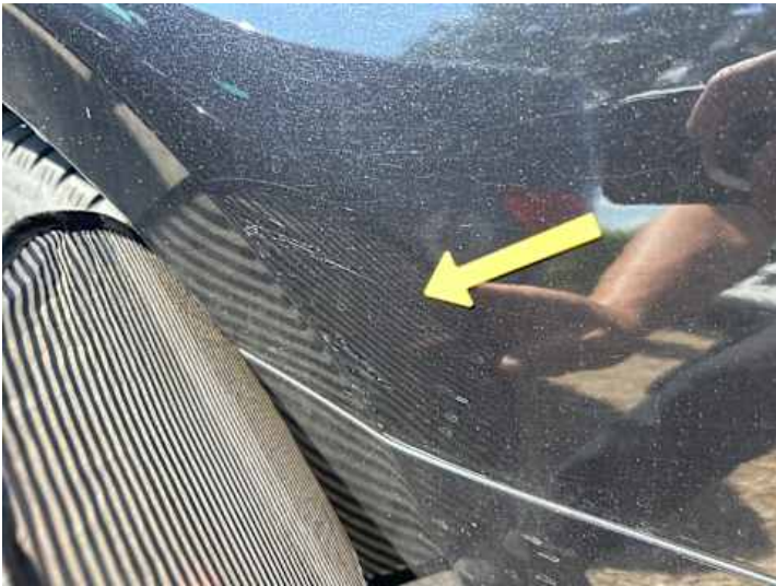
Seitenteil hinten links (Kratzer, Verformung)
