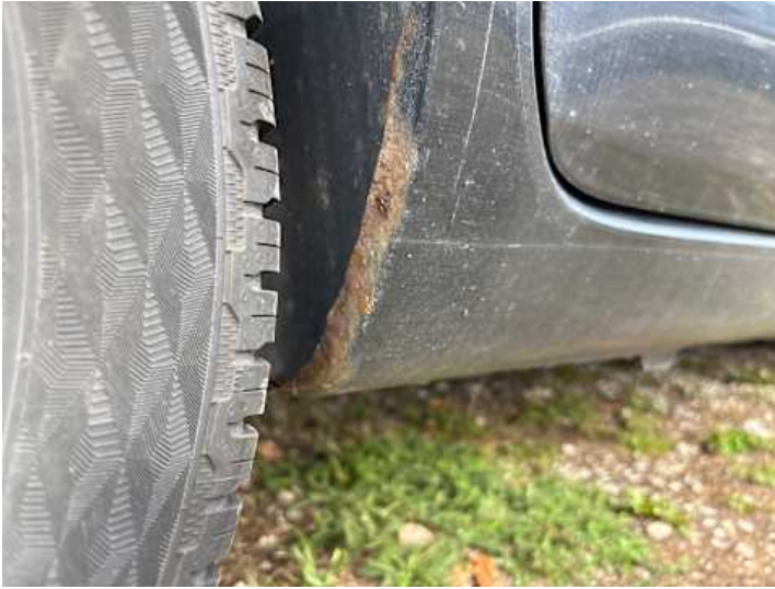
Schweller rechts (Rost)
