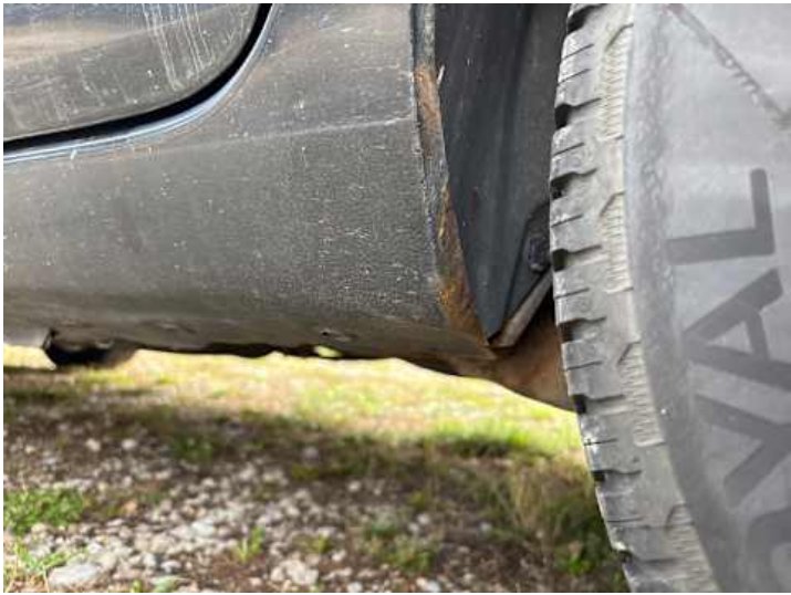
Schweller links (Rost)
