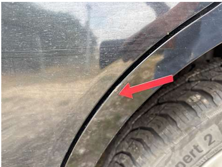
Seitenteil hinten links (Rost)
