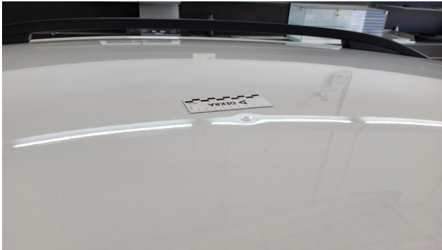
Dach - Delle entfernen
