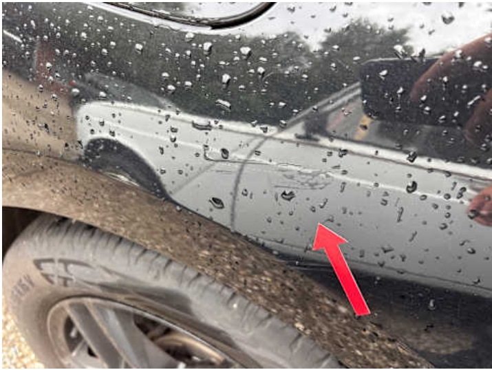
Seitenteil hinten rechts (Kratzer)
