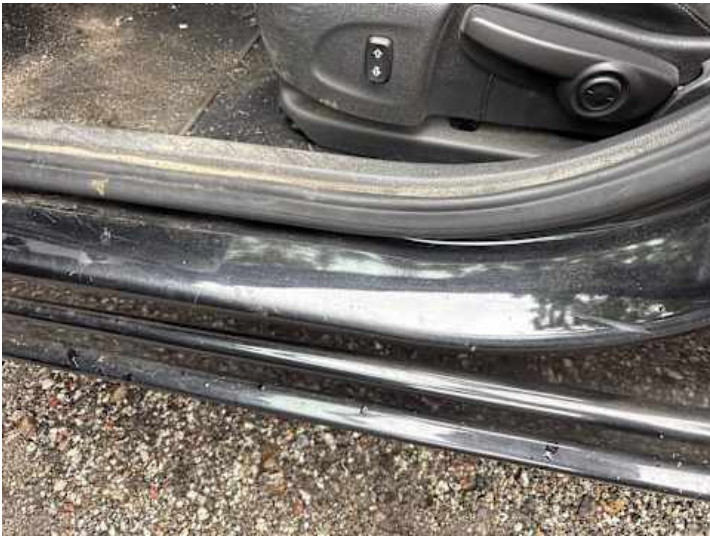
Schweller links (Kratzer)
