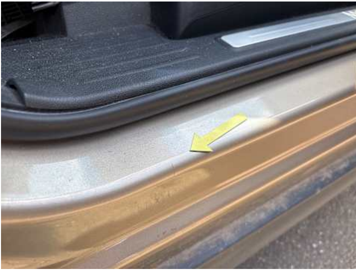
Schweller rechts (Kratzer)
