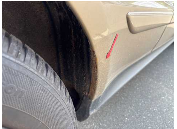
Seitenteil hinten rechts (Rost)
