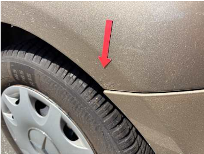
Seitenteil hinten links (Rost)
