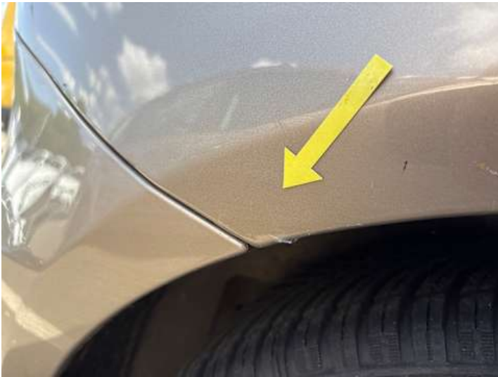
Seitenteil hinten rechts (Rost)
