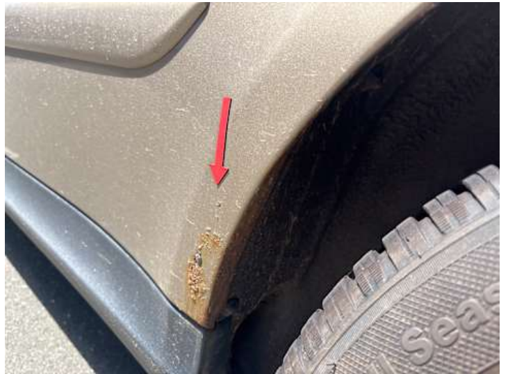
Seitenteil hinten links (Rost)
