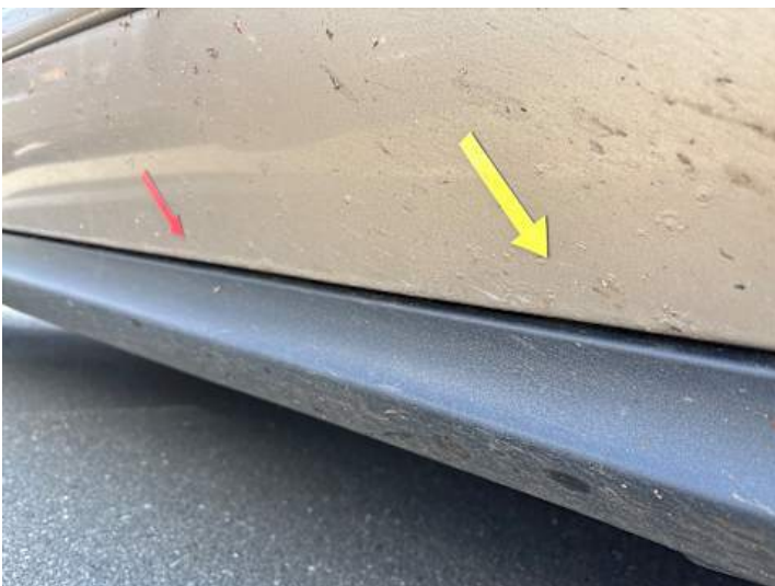
Beifahrtür (Lackschaden, Rost)
