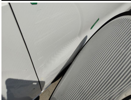
Tür / Rechts / Delle
