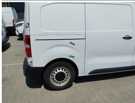
Seitenwand / Hinten Rechts / Delle
