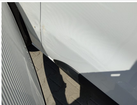
Tür / Rechts / Delle
