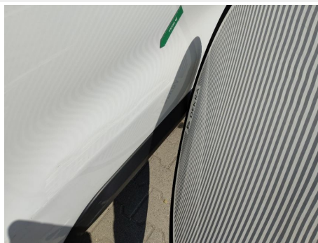
Tür / Rechts / Delle
