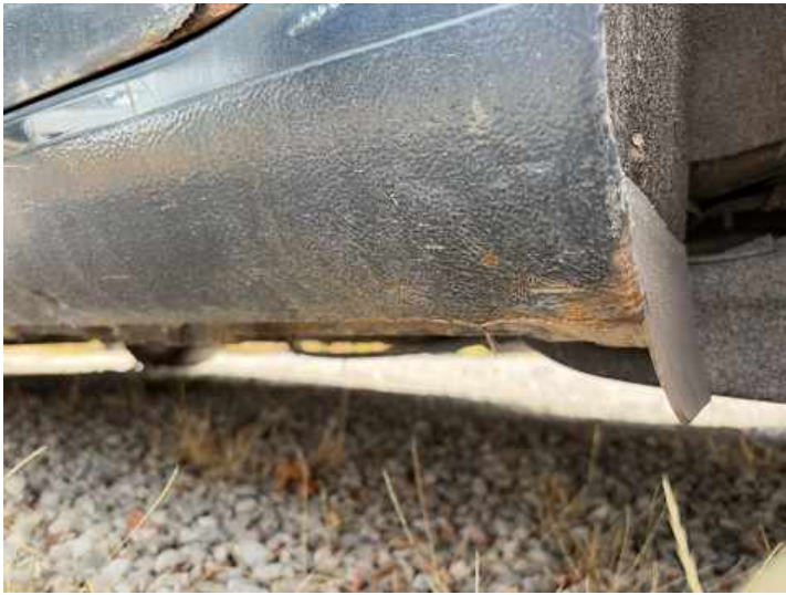
Schweller links (Rost)
