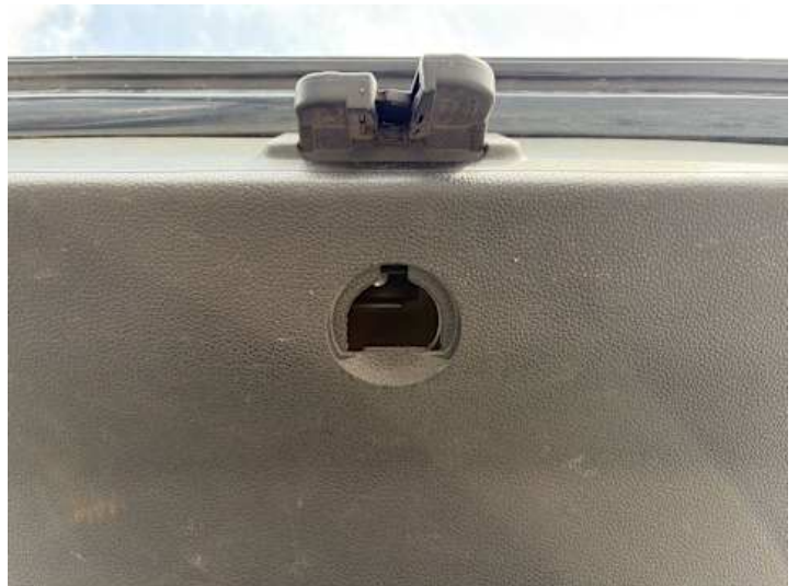
Innenraum (Anderer Schaden): Abdeckung fehlt
