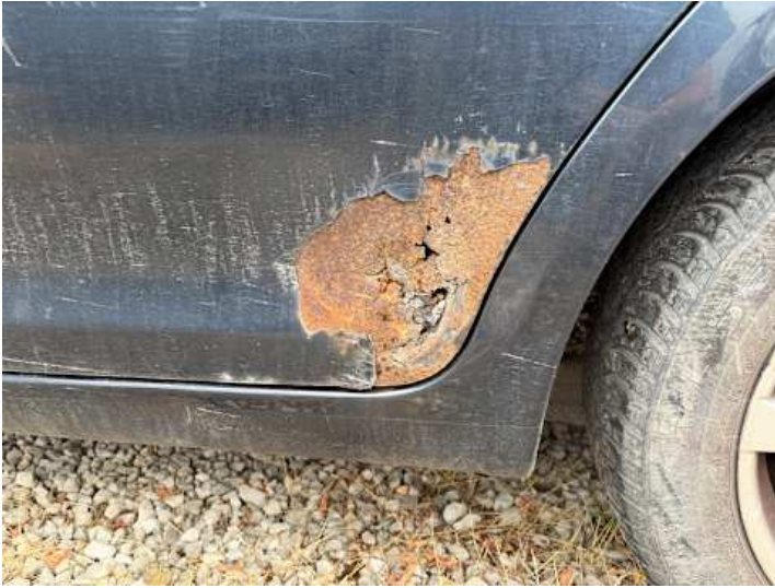
Türe hinten links (Rost)
