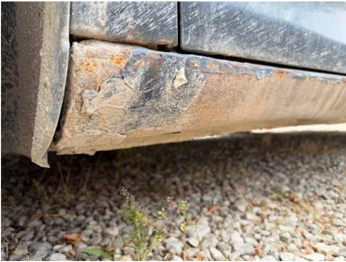
Schweller links (Rost)
