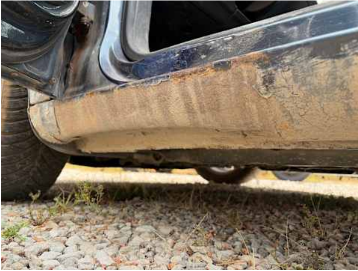
Schweller links (Rost)
