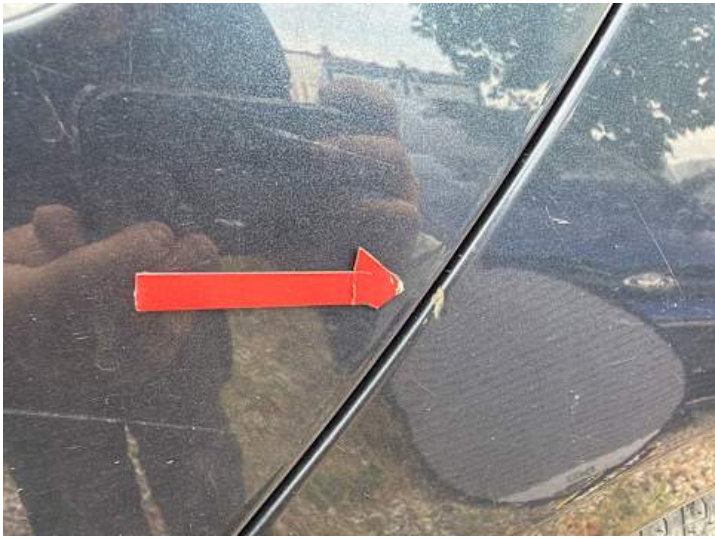
Seitenteil hinten links (Lackschaden, Rost)
