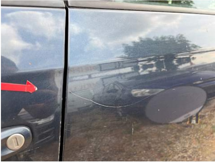
Türe hinten links (Kratzer)
