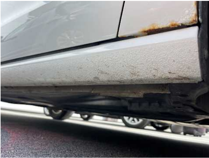
Schweller rechts (Lackschaden, Unsachgemäß instand gesetzt)
