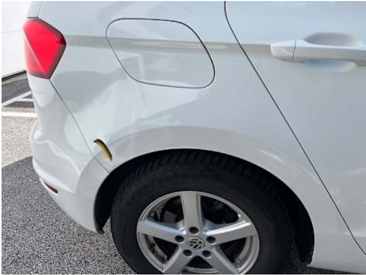
Seitenteil hinten rechts (Lackschaden, Rost, Unsachgemäß instand gesetzt, Delle)
