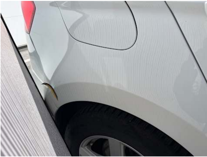
Seitenteil hinten rechts (Lackschaden, Rost, Unsachgemäß instand gesetzt, Delle)
