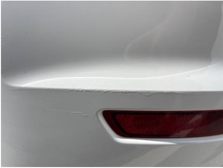
Stoßstange hinten (Lackschaden, Kratzer, Unsachgemäß instand gesetzt)
