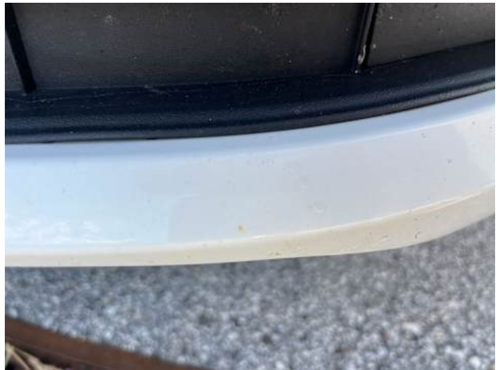
Stoßstange vorne (Lackschaden, Kratzer, Unsachgemäß instand gesetzt)
