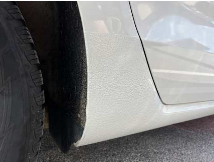
Schweller rechts (Lackschaden, Unsachgemäß instand gesetzt)
