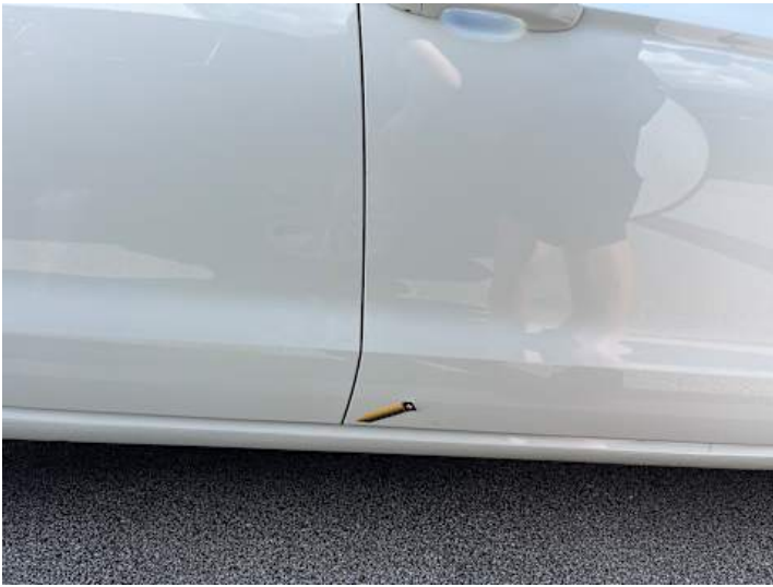
Beifahrertür (Lackschaden, Rost, Unsachgemäß instand gesetzt)
