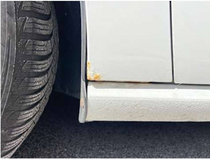
Kotflügel vorne links (Lackschaden, Rost)
