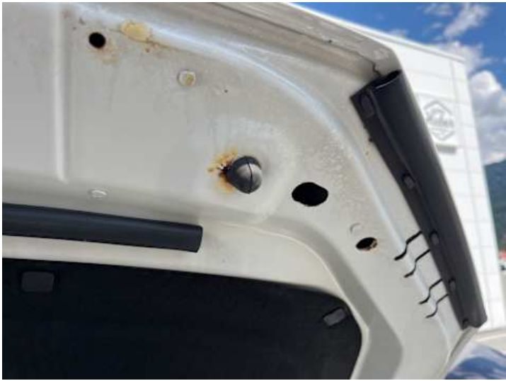
Motorhaube (Lackschaden, Rost)
