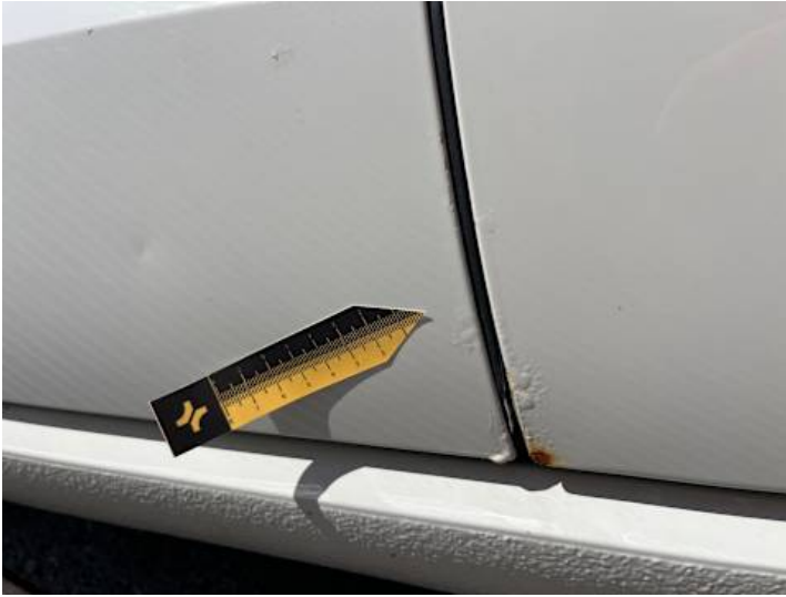
Fahrtür (Lackschaden, Rost, Unsachgemäß instand gesetzt)
