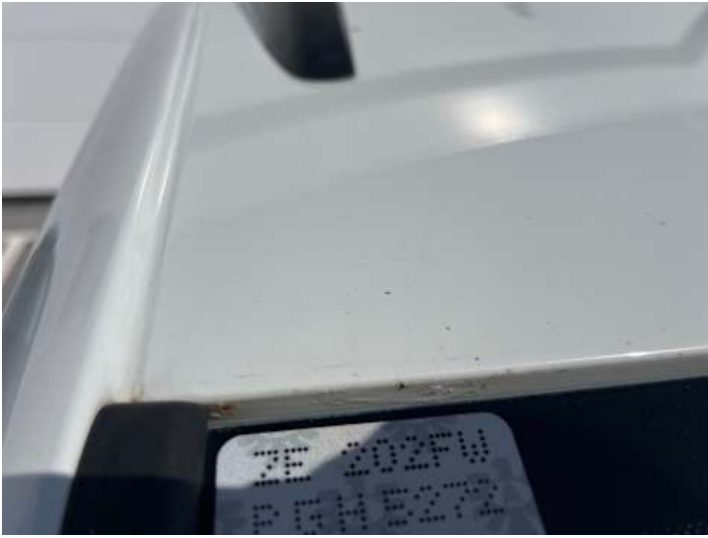
Dach (Steinschlag, Lackschaden, Unsachgemäß instand gesetzt)
