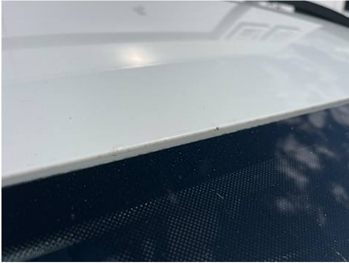
Dach (Steinschlag, Lackschaden, Unsachgemäß instand gesetzt)
