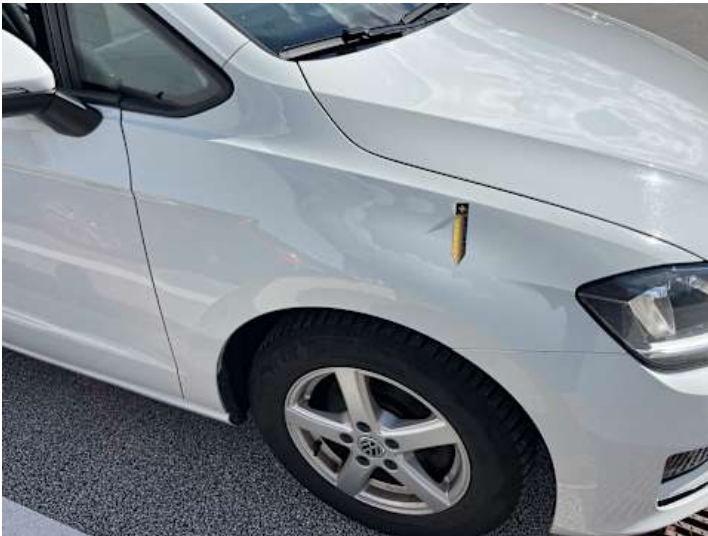
Kotflügel vorne rechts (Lackschaden, Rost)
