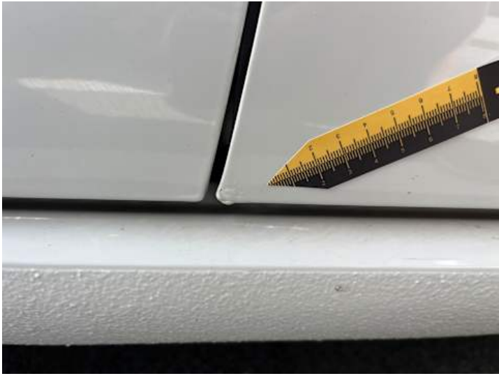
Beifahrertür (Lackschaden, Rost, Unsachgemäß instand gesetzt)
