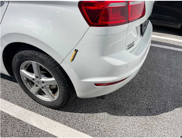
Stoßstange hinten (Lackschaden, Kratzer, Unsachgemäß instand gesetzt)
