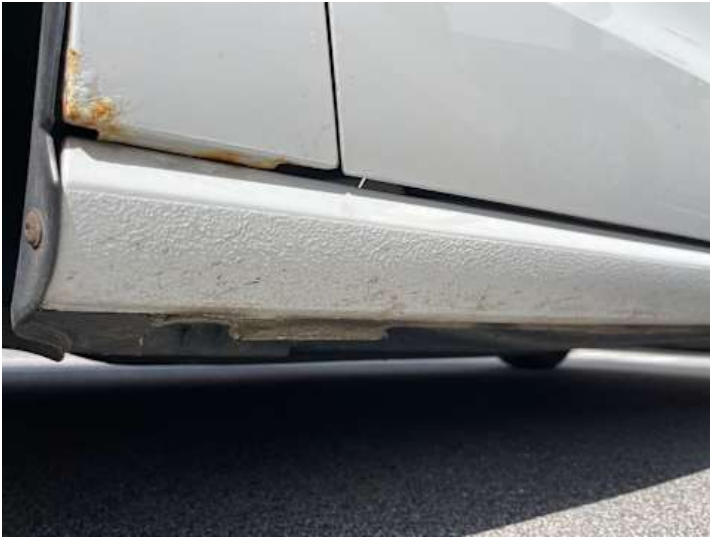
Schweller links (Lackschaden, Unsachgemäß instand gesetzt)
