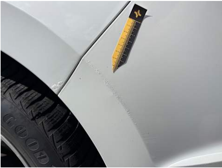
Stoßstange hinten (Lackschaden, Kratzer, Unsachgemäß instand gesetzt)
