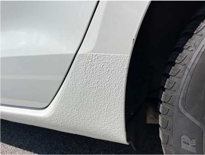
Schweller links (Lackschaden, Unsachgemäß instand gesetzt)
