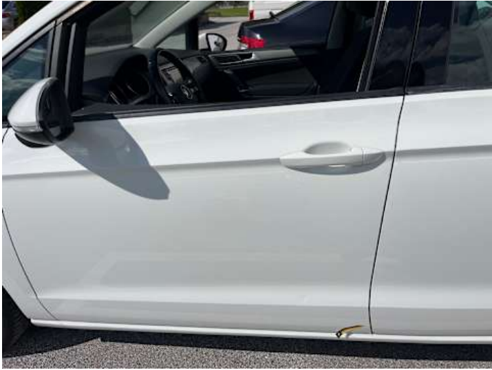
Fahrtür (Lackschaden, Rost, Unsachgemäß instand gesetzt)
