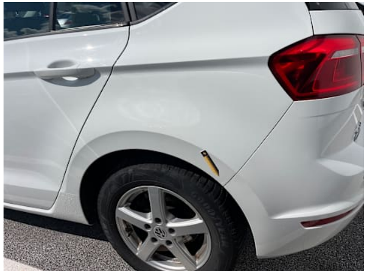
Seitenteil hinten links (Lackschaden, Rost, Unsachgemäß instand gesetzt)
