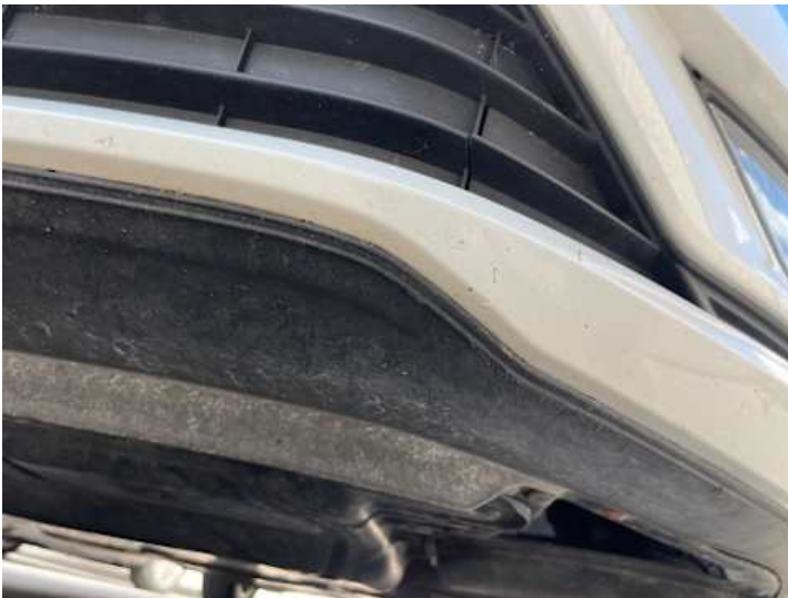
Stoßstange vorne (Lackschaden, Kratzer, Unsachgemäß instand gesetzt)
