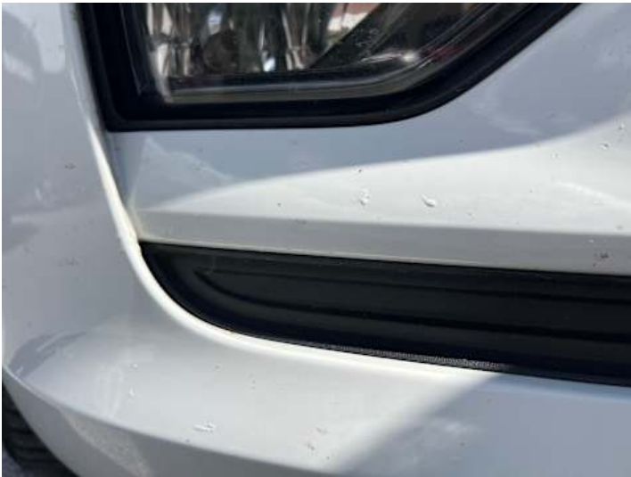
Stoßstange vorne (Lackschaden, Kratzer, Unsachgemäß instand gesetzt)
