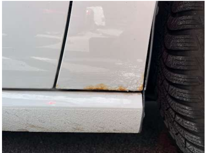
Kotflügel vorne rechts (Lackschaden, Rost)
