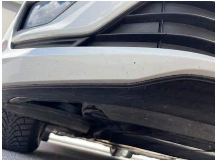
Stoßstange vorne (Lackschaden, Kratzer, Unsachgemäß instand gesetzt)
