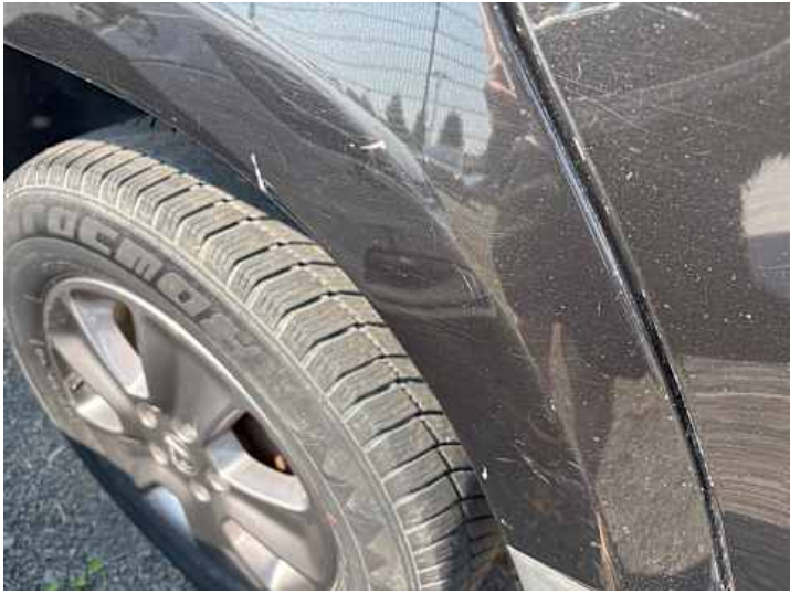
Seitenteil hinten rechts (Lackschaden, Kratzer)
