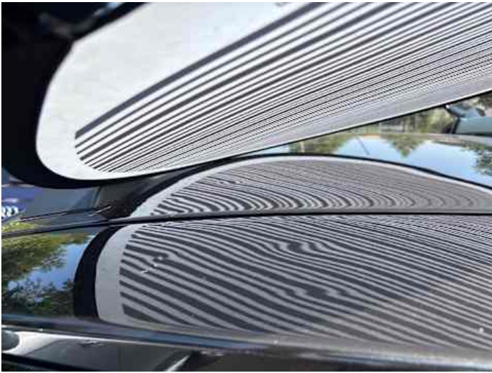
Dach (Delle, Kratzer)
