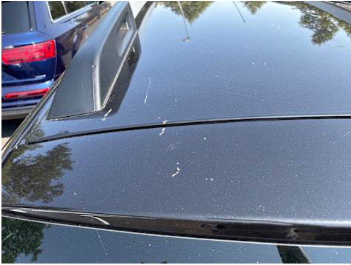
Dach (Delle, Kratzer)
