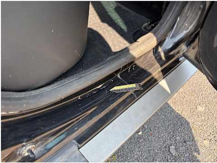
Schweller rechts (Delle, Kratzer)
