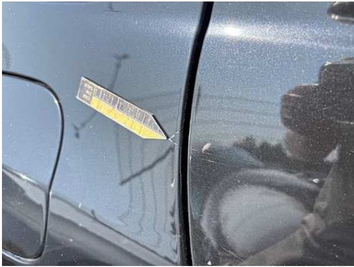
Seitenteil hinten rechts (Lackschaden, Kratzer)
