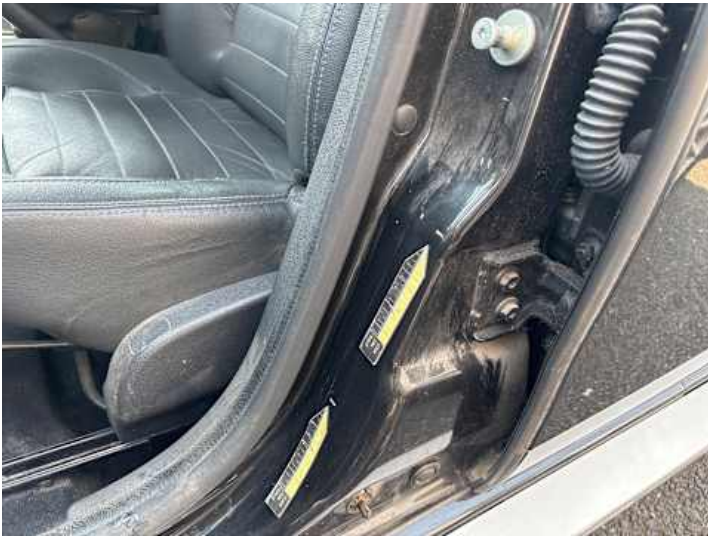
Schweller links (Kratzer, Rost)
