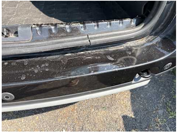
Stoßstange hinten (Verformung, Kratzer)
