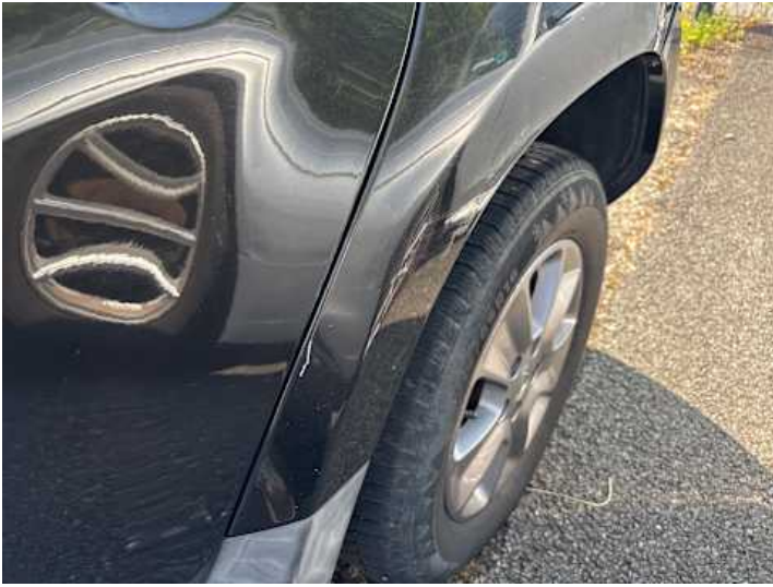
Seitenteil hinten links (Verformung, Kratzer, Delle)
