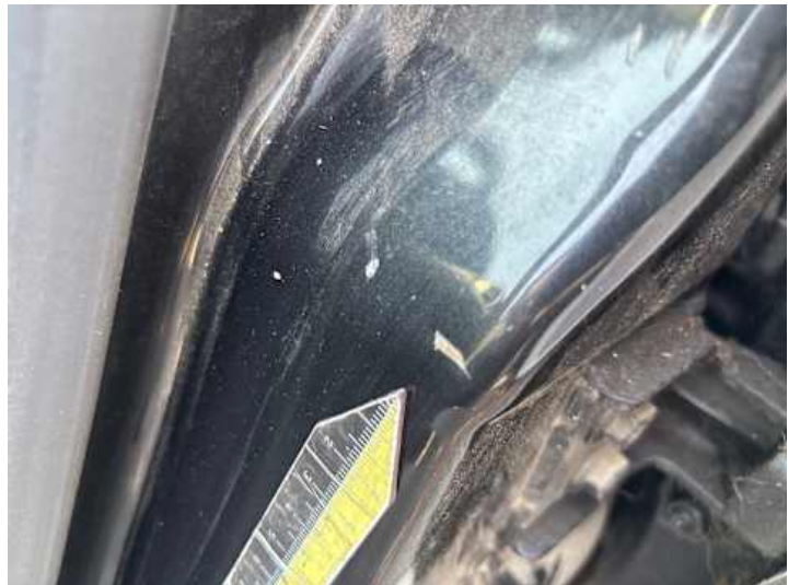
Schweller links (Kratzer, Rost)
