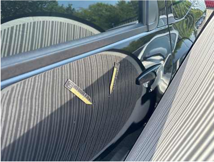
Türe hinten links (Delle, Kratzer)
