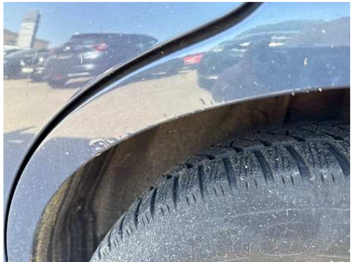
Seitenteil hinten links (Lackschaden, Kratzer, Rost)
