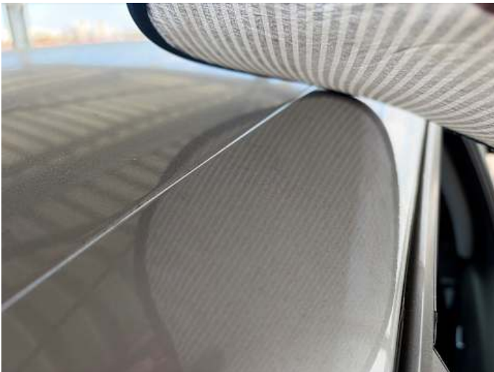
Dach (Delle, Anderer Schaden): Hagelschaden
