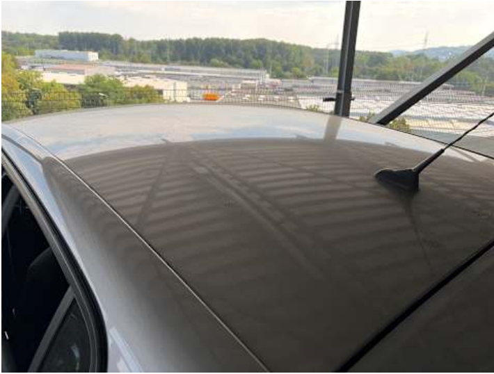
Dach (Delle, Anderer Schaden): Hagelschaden
