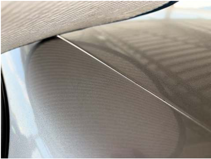
Dach (Delle, Anderer Schaden): Hagelschaden
