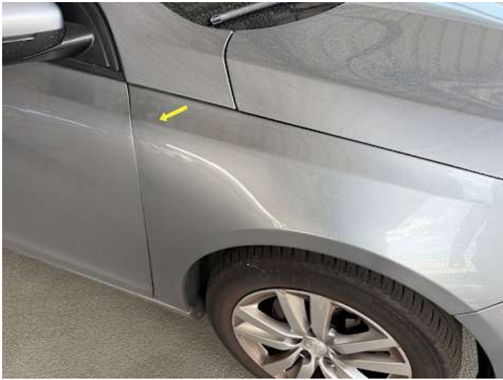
Kotflügel vorne rechts (Kratzer, Delle)
