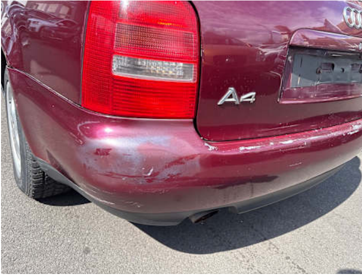
Stoßstange hinten (Lackschaden, Unsachgemäß instand gesetzt)
