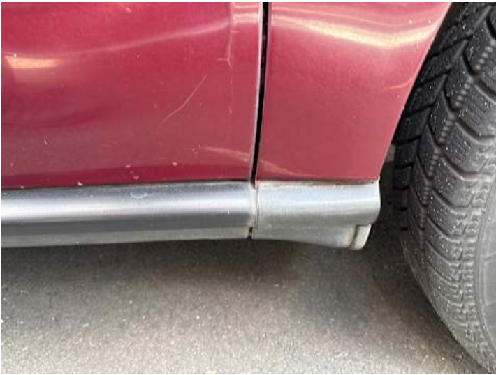
Schweller rechts (Spaltmaße ungenau)
