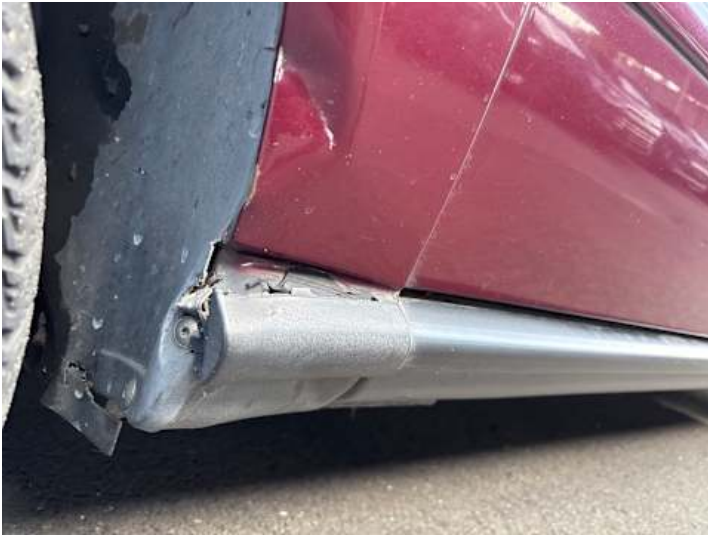
Schweller links (Riss/Bruch, Verformung)
