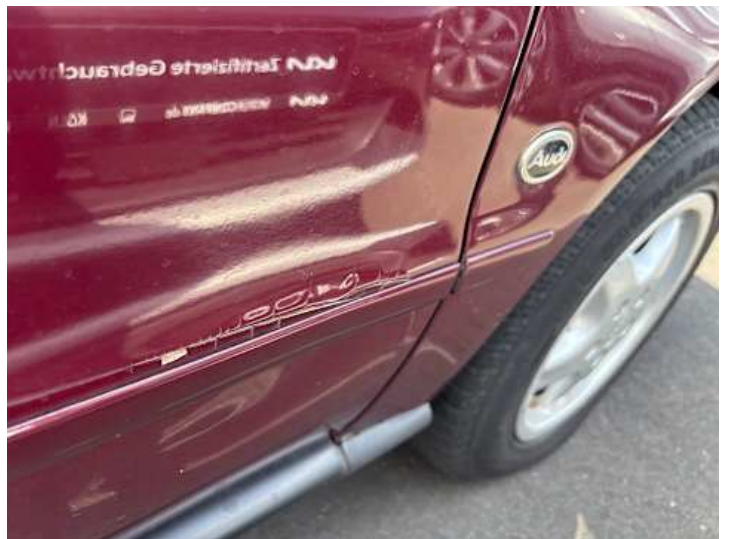
Beifahrertür (Lackschaden, Verformung)
