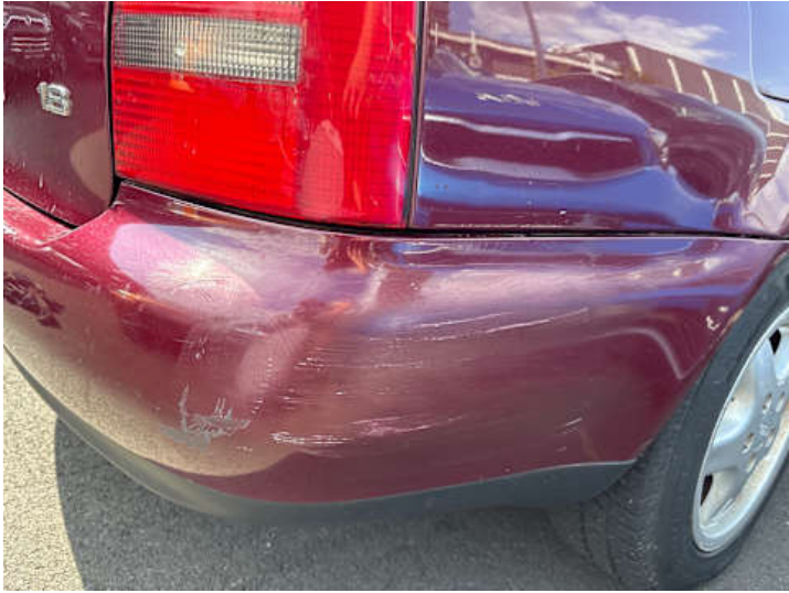
Stoßstange hinten (Spaltmaße ungenau)
