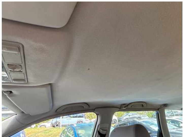
Innenraum (Anderer Schaden): Dachhimmel hängt
