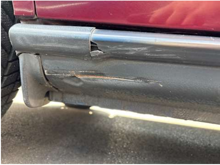
Schweller rechts (Verformung, Rost)
