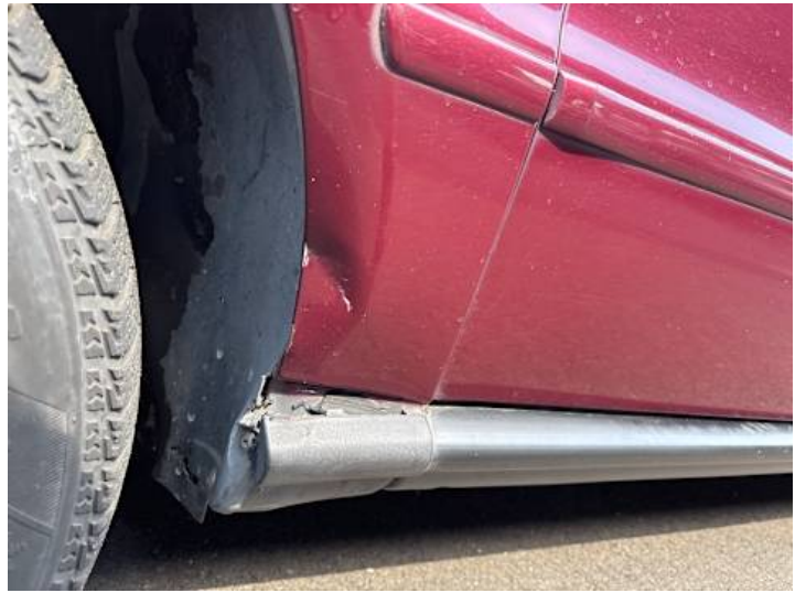
Kotflügel vorne links (Verformung)
