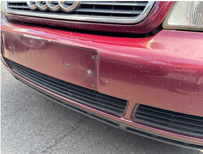
Stoßstange vorne (Lackschaden, Unsachgemäß instand gesetzt, Spaltmaße ungenau)
