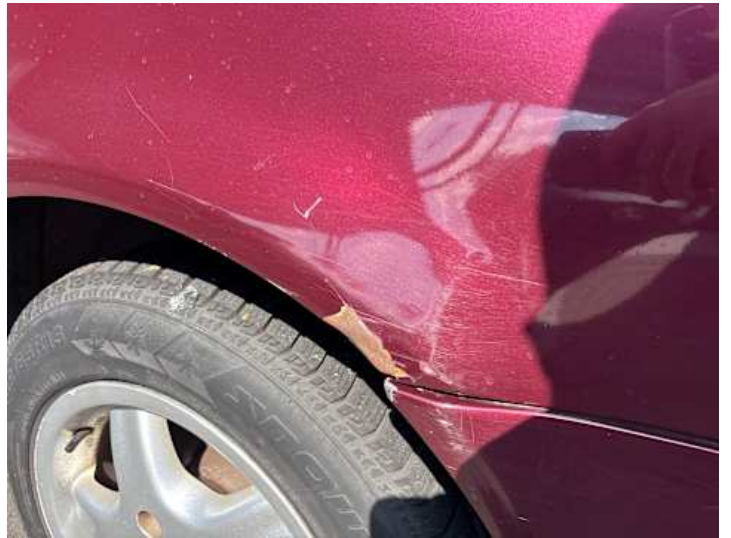
Seitenteil hinten links (Rost, Lackschaden, Verformung)
