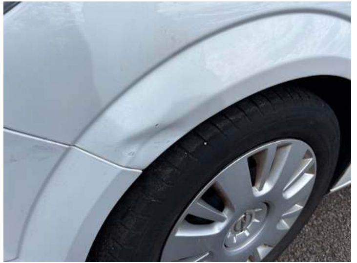
Kotflügel vorne links (Verformung, Lackschaden)
