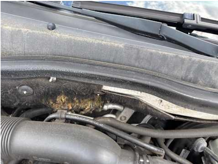
Motorhaube (Anderer Schaden): Dämmung
