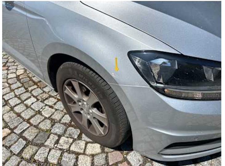
Kotflügel vorne rechts (Kratzer, Delle)
