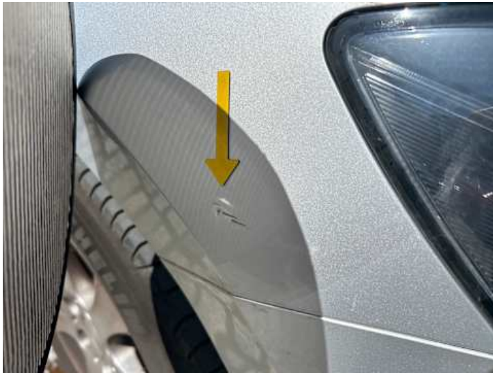
Kotflügel vorne rechts (Kratzer, Delle)
