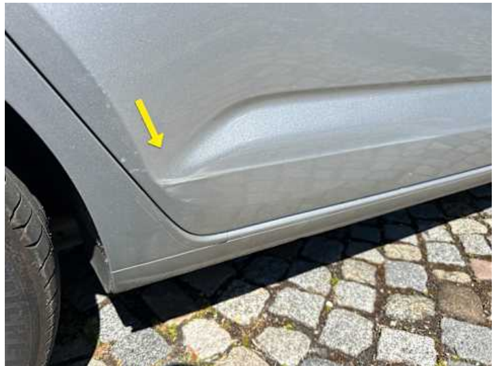
Türe hinten rechts (Kratzer, Verformung)
