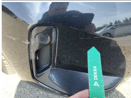
Stoßfänger / Vorne / Delle
