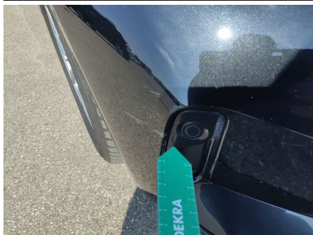
Stoßfänger / Vorne / Delle
