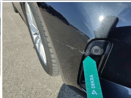
Stoßfänger / Vorne / Delle
