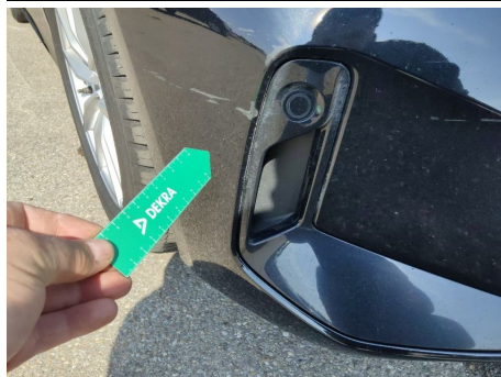
Stoßfänger / Vorne / Delle
