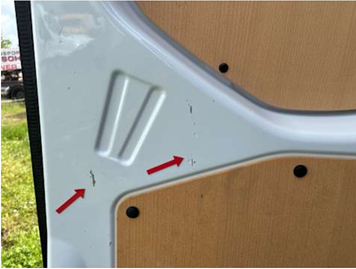
Heckklappe (Verformung, Kratzer)
