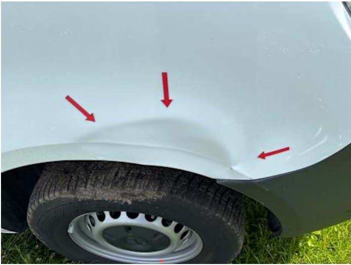
Kotflügel vorne rechts (Verformung, Kratzer)
