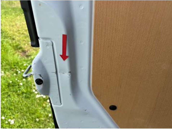
Heckklappe (Verformung, Kratzer)
