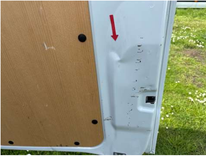
Heckklappe (Verformung, Kratzer)
