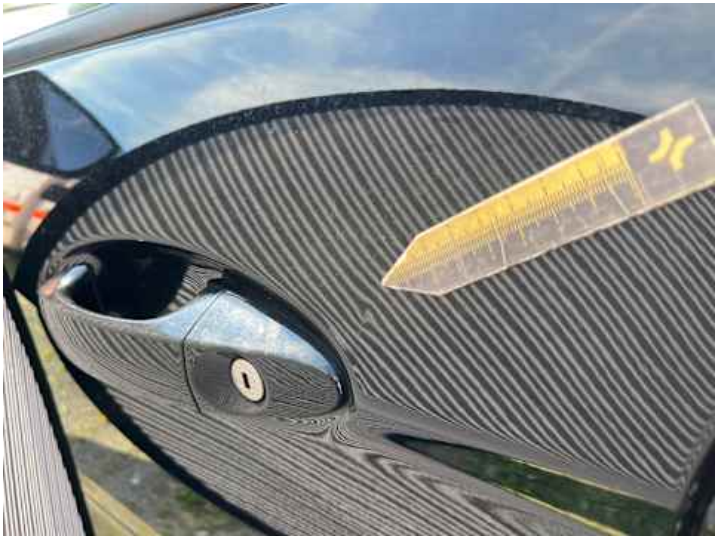
Fahrtür (Delle, Kratzer)
