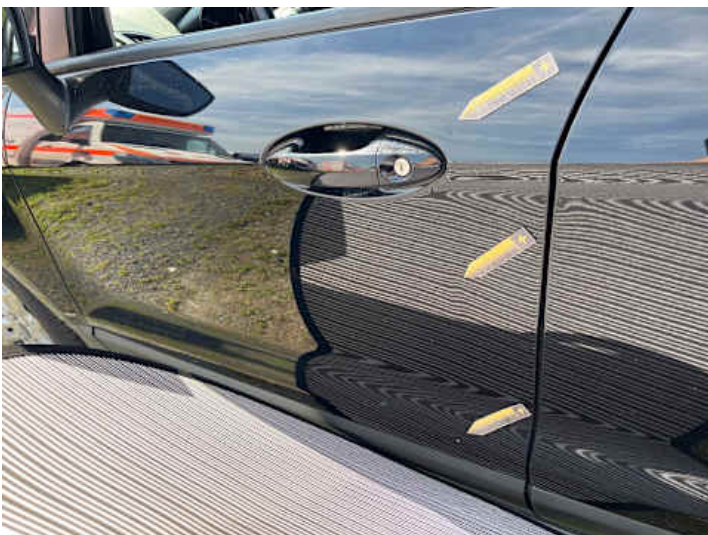
Fahrtür (Delle, Kratzer)
