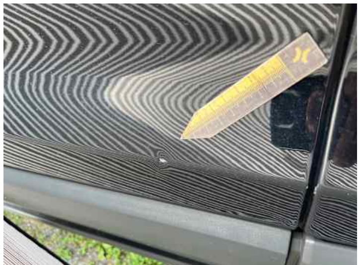
Fahrtür (Delle, Kratzer)
