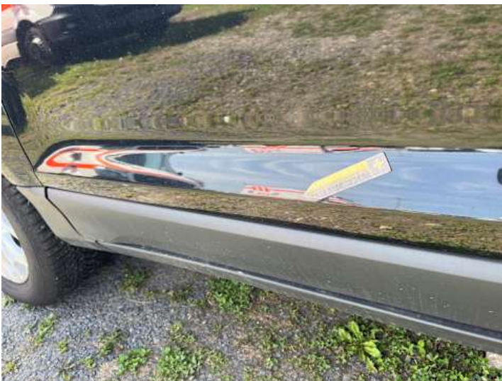
Fahrtür (Delle, Kratzer)
