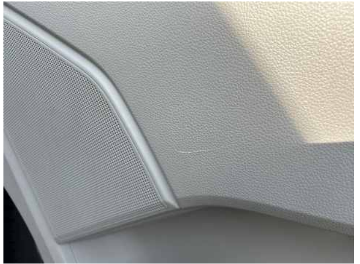
Innenraum (Kratzer, Riss/Bruch)
