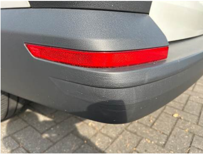
Stoßstange hinten (Kratzer, Verformung)
