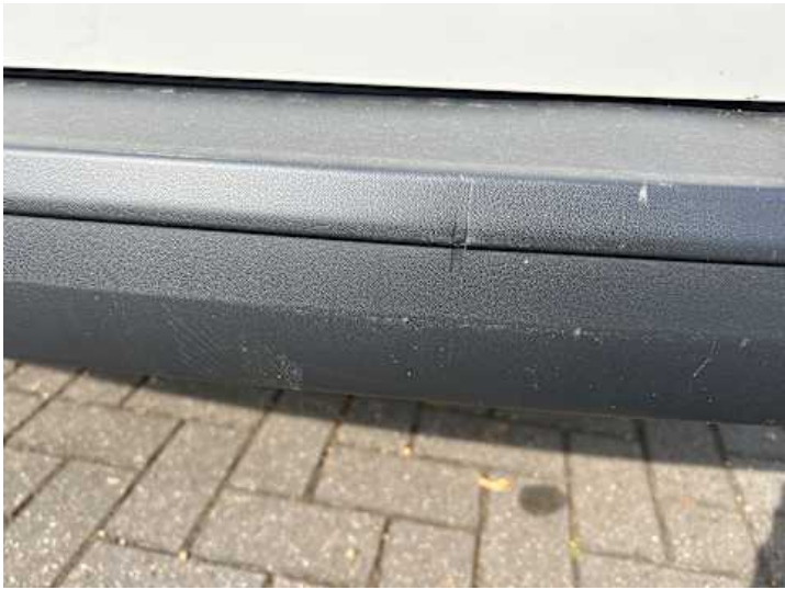
Stoßstange hinten (Kratzer, Verformung)
