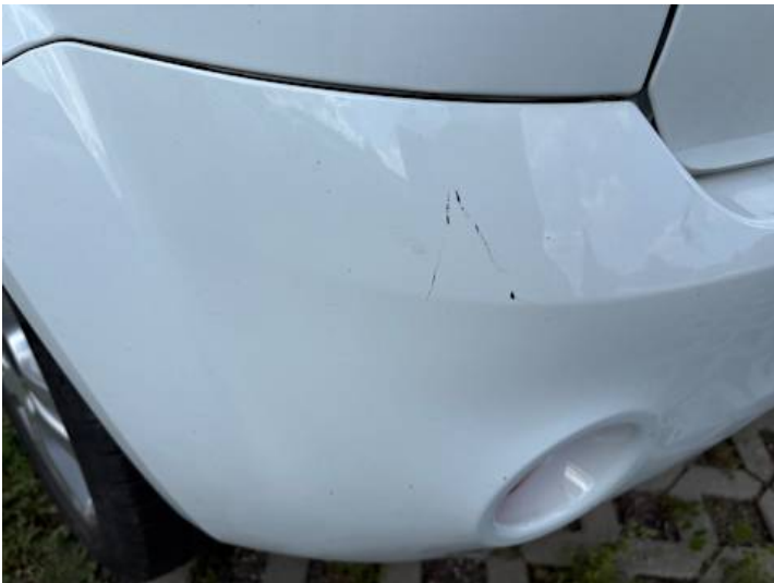
Stoßstange hinten (Lackschaden, Kratzer)
