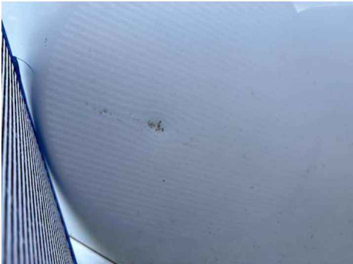
Beifahrertür (Delle, Kratzer)
