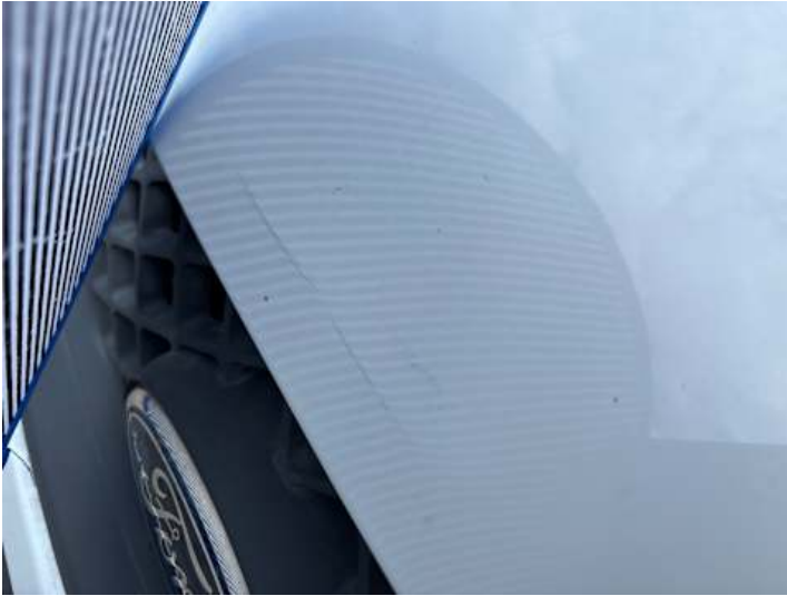
Motorhaube (Lackschaden, Rost, Delle)
