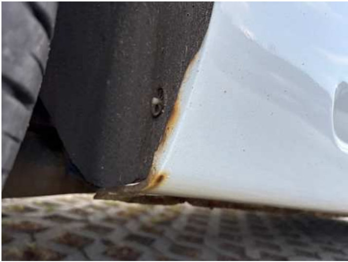
Schweller rechts (Rost)
