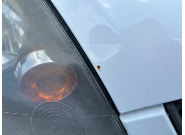
Motorhaube (Lackschaden, Rost, Delle)
