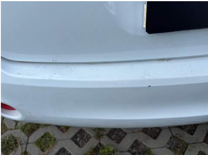
Stoßstange hinten (Lackschaden, Kratzer)
