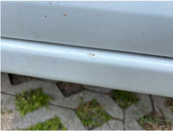
Schweller links (Rost)
