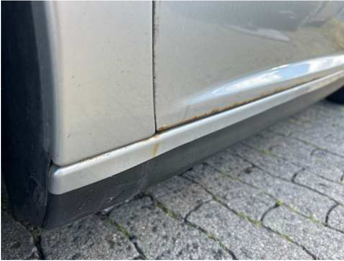
Schweller links (Rost)
