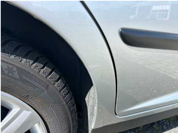
Seitenteil hinten rechts (Kratzer, Rost)
