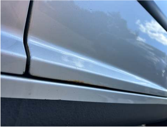
Türe hinten links (Rost)
