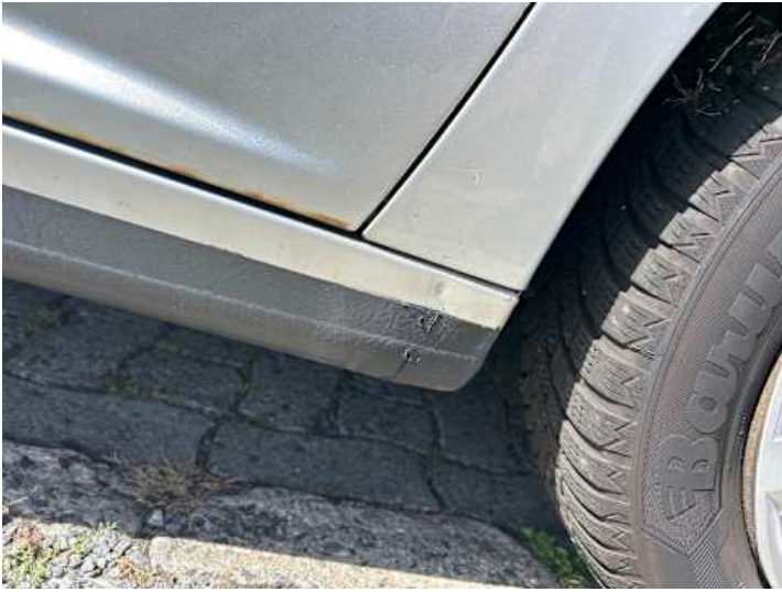
Schweller rechts (Delle)
