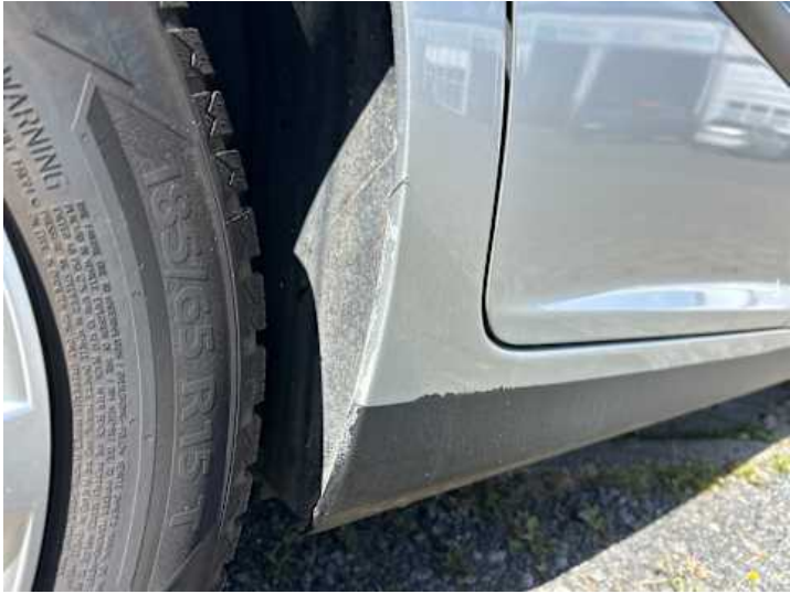
Schweller rechts (Lackschaden)
