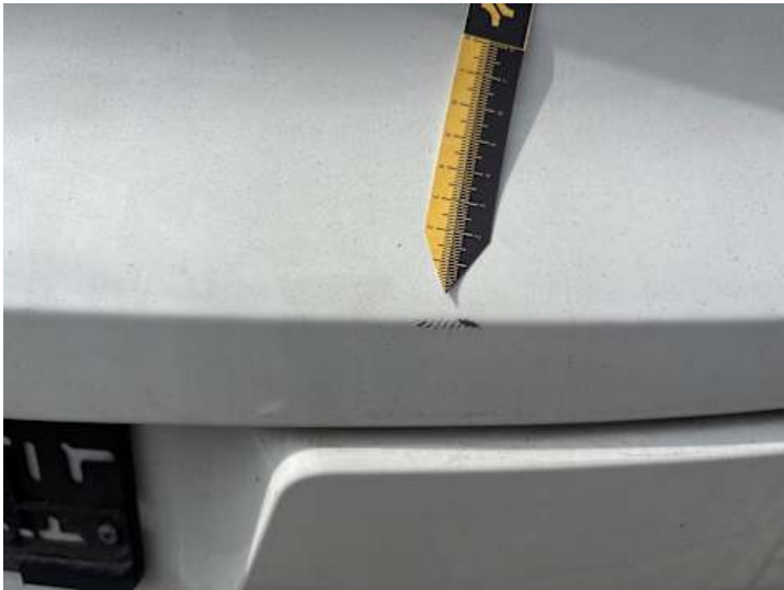
Heckklappe (Lackschaden, Kratzer)
