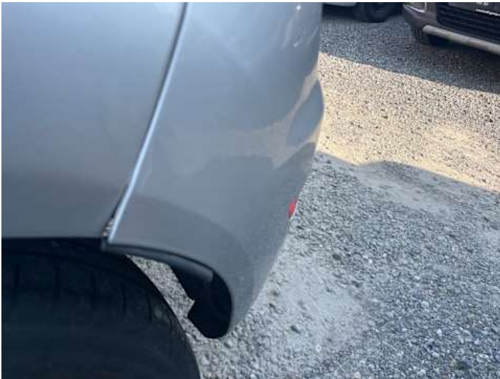
Stoßstange hinten (Spaltmaße ungenau)
