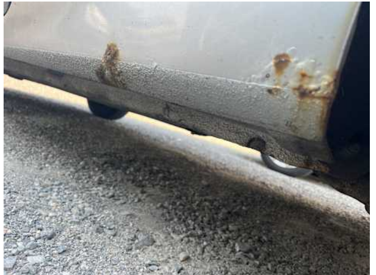
Schweller links (Rost)
