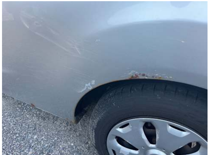
Seitenteil hinten links (Lackschaden, Rost, Verformung)
