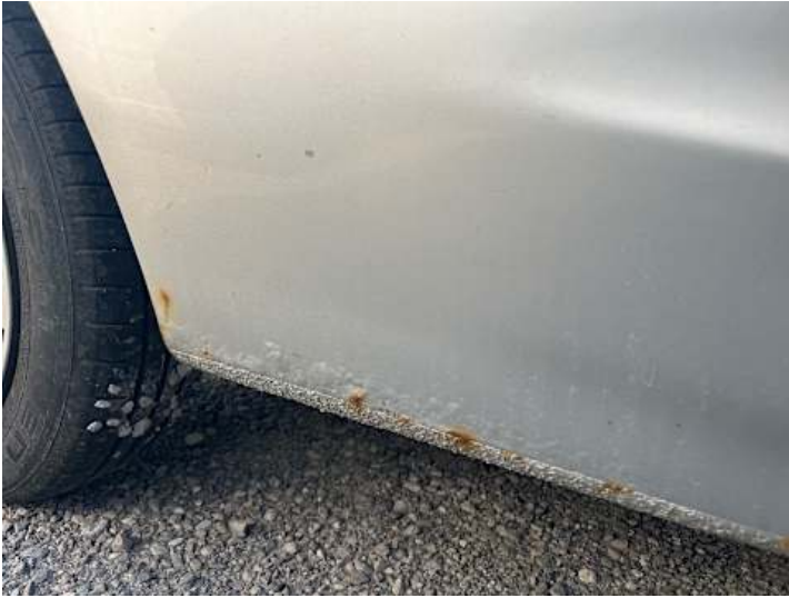
Seitenteil hinten rechts (Rost, Lackschaden)
