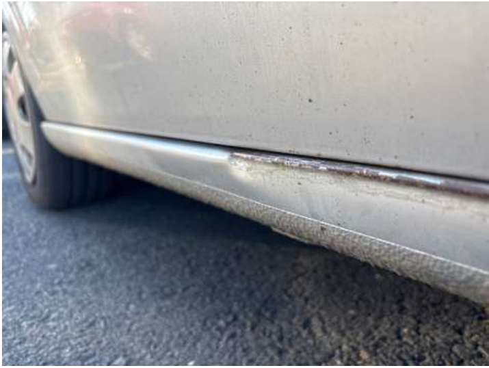
Schweller links (Verformung)
