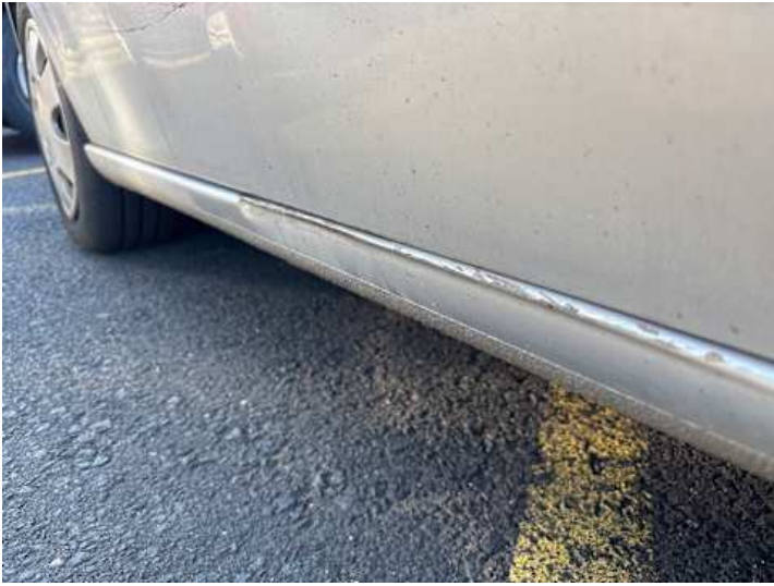
Schweller links (Kratzer, Rost)
