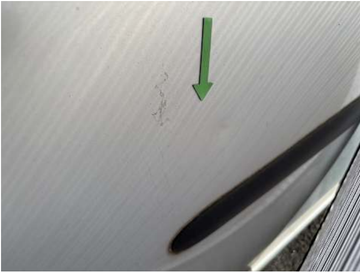
Türe hinten rechts (Delle)
