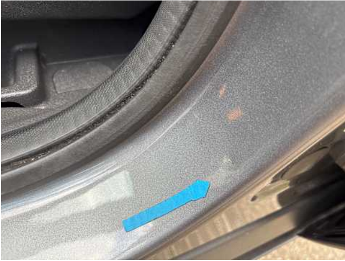
Schweller links (Delle, Kratzer)
