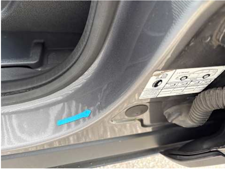
Schweller links (Delle, Kratzer)
