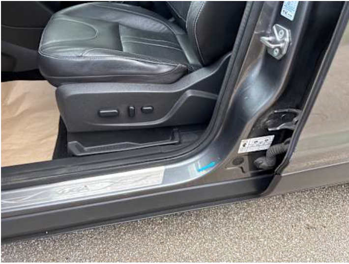
Schweller links (Delle, Kratzer)
