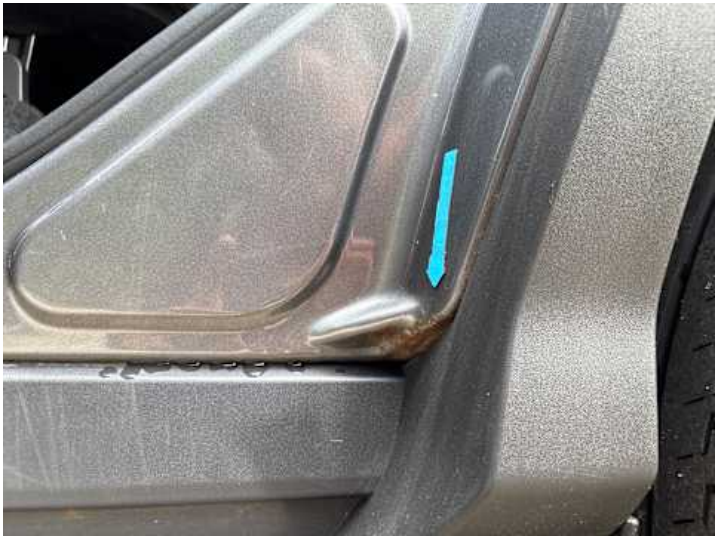
Schweller links (Rost)
