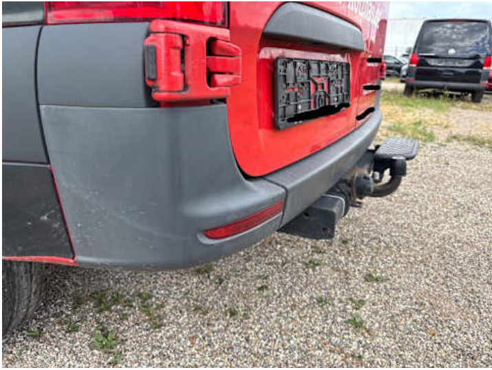
Stoßstange hinten (Kratzer, Verformung, Ausgeblichen/Matt)
