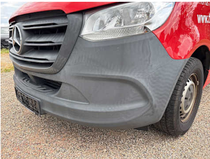
Stoßstange vorne (Ausgeblichen/Matt, Kratzer)
