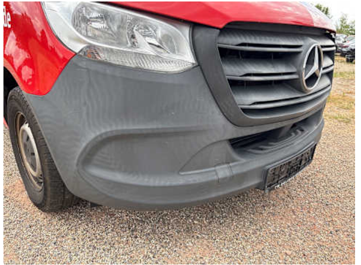
Stoßstange vorne (Ausgeblichen/Matt, Kratzer)
