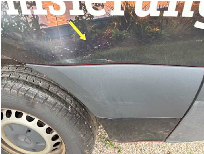
Seitenteil hinten links (Kratzer)
