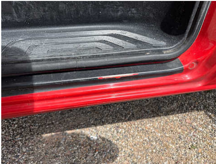
Schweller links (Kratzer)
