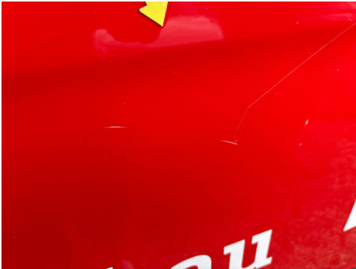
Seitenteil hinten links (Kratzer)
