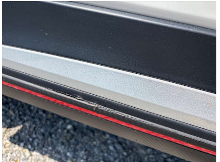
Fahrertür (Unsachgemäß instand gesetzt)
