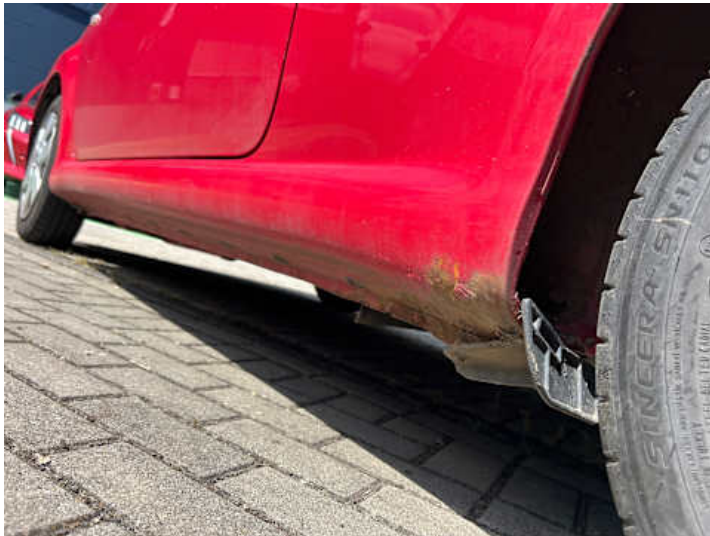
Schweller links (Rost)
