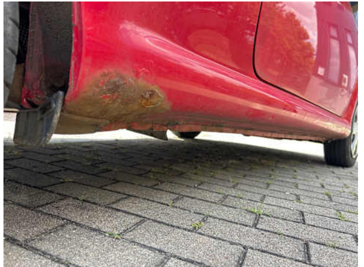
Schweller rechts (Rost)
